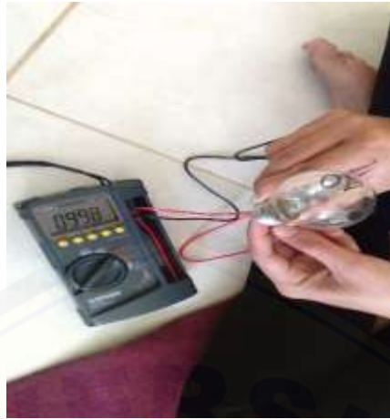
Gambar 6. Pengukuran Tahanan Beban Lampu 40 watt
