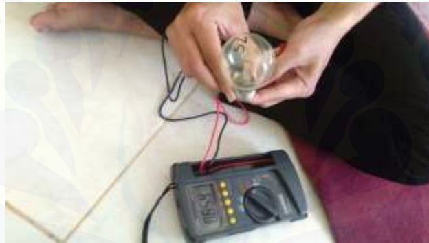
Gambar 7. Pengukuran Tahanan Beban Lampu 75 watt
