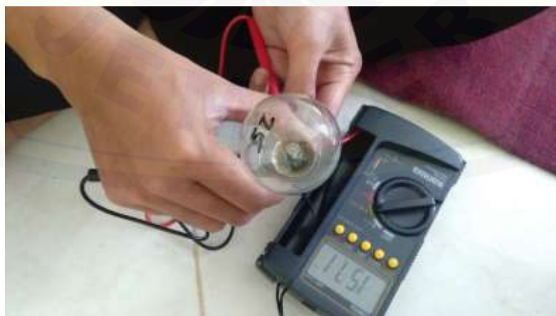
Gambar 5. Pengukuran Tahanan Beban Lampu 25 watt
