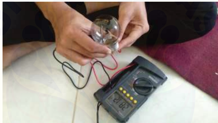
Gambar 4. Pengukuran Tahanan Beban Lampu 15 watt
