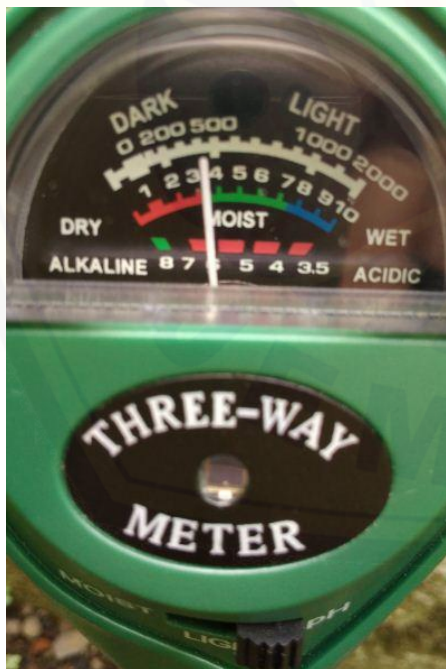
Pengukuran kelembaban tanah dan ph tanah
