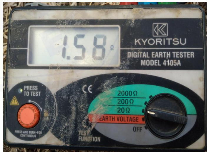
Beberapa Hasil Pengukuran menggunakan Earth Tester pada Tower 1, 2 dan 3
