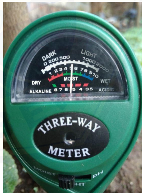
Pengukuran kelembaban tanah dan ph tanah
