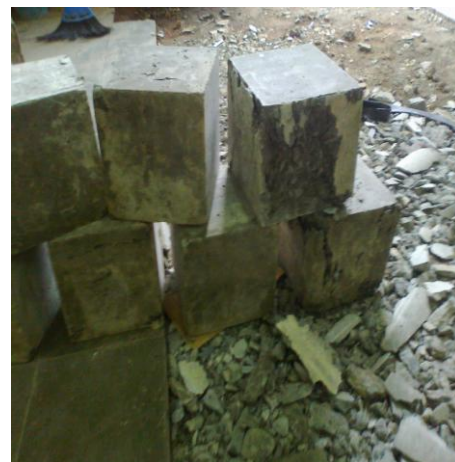
Beton setelah diuji
