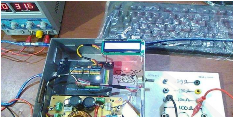
B2. Gambar pengujian konverter menggunakan beban Resistor
