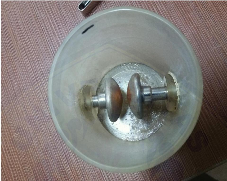
**Gambar Gelas Pengujian Tegangan Tembus**
