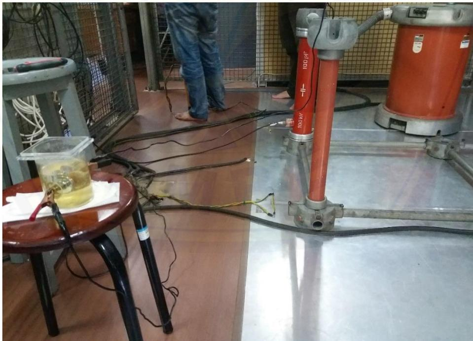
**Gambar Rangkaian Pengujian Tegangan Tembus**
