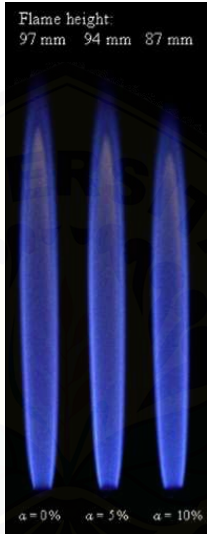
Gambar 2.3 Diffusion Flame Biogas dengan Hydrogen (Zhen dkk, 2014)
