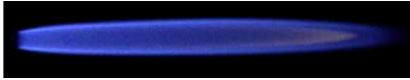
Gambar 2.4 Api Laminar pada diffusion flame biogas dengan hydrogen (Zhen dkk, 2014)
