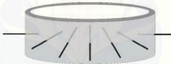
Gambar 3.9 Peletakan elektroda pada tabung tampak samping
