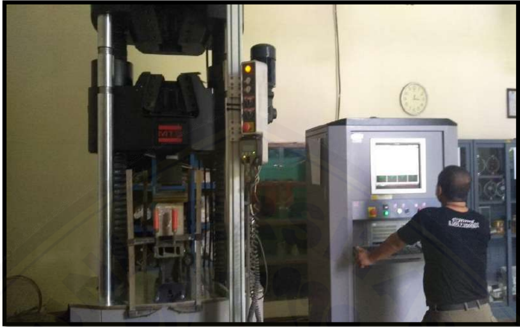
Gambar 2.9 Alat Uji Kuat Lentur
