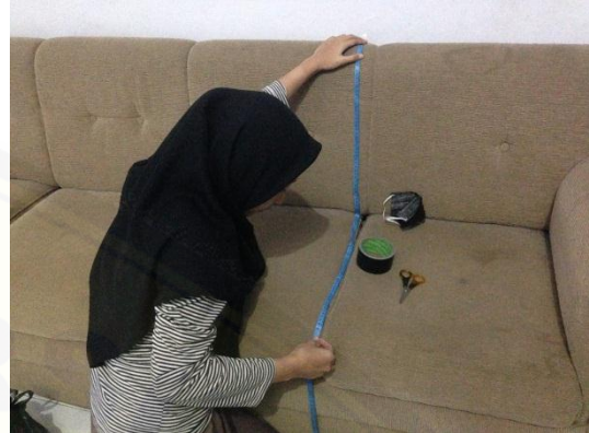
Gambar 2. Pengukuran dan penandaan area seluas 1 m 2 menggunakan meteran dan lakban
