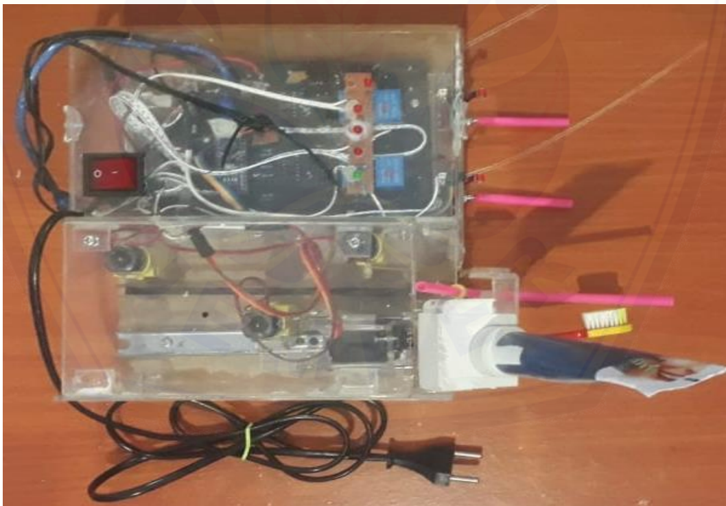
Gambar 2.3 Komponen dalam pada alat sikat gigi otomatis wall mounted
