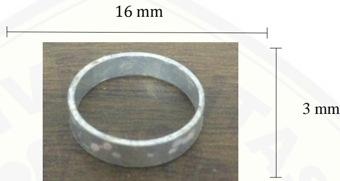
Gambar 3.2 Cetakan sampel berbahan aluminium berbentuk silinder berongga dengan diameter 16 mm dan ketebalan 3 mm (Sumber: Dokumentasi Pribadi)
