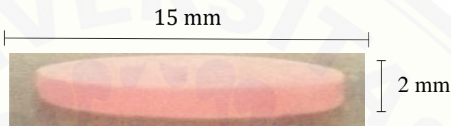
Gambar 3.1 Sampel resin akrilik berbentuk silinder dengan diameter 15 mm dan ketebalan 2 mm (Sumber: Dokumentasi Pribadi).
