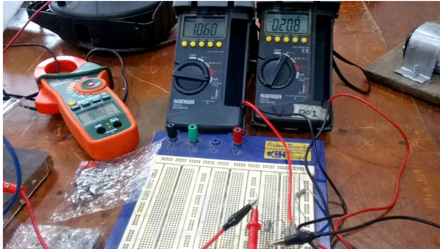
Gambar 3. Pengujian Generator Pada Output Tegangan 20 V Menggunakan Multimeter
