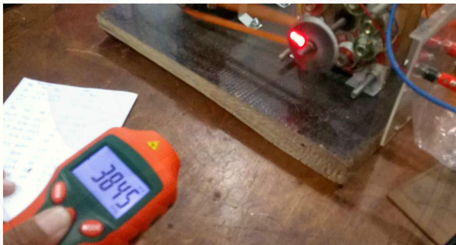
Gambar 6. Pengujian Generator Pada Output Tegangan 23 V Menggunakan Tachometer
