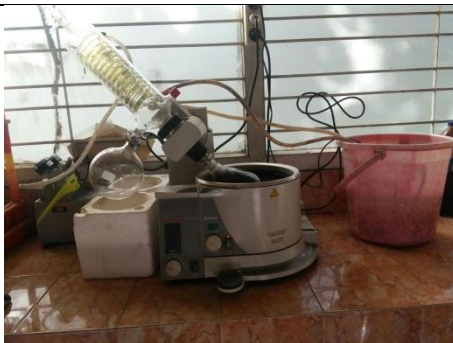
Gambar 13. Menguapkan dengan rotary evaporatory
