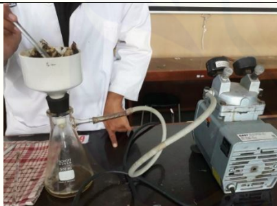
Gambar 11. Penyaringan hasil maserasi
