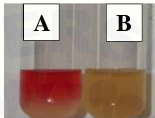
(A) Uji methyl red positif; (B) Uji methyl red negatif
