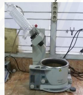
Pemisahan Etanol dari ekstrak bawang bombay menggunakan rotary evaporator
