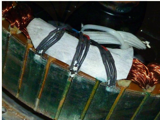
Gambar 2.5 Penempatan sensor medan magnet pada stator
