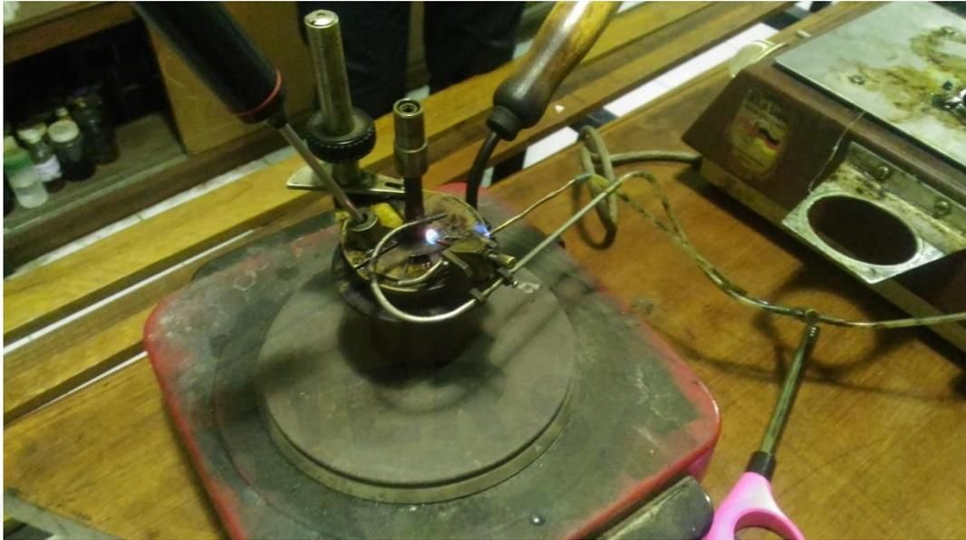
Gambar B.5 Pengujian *flash point* (titik nyala) minyak pirolisis
