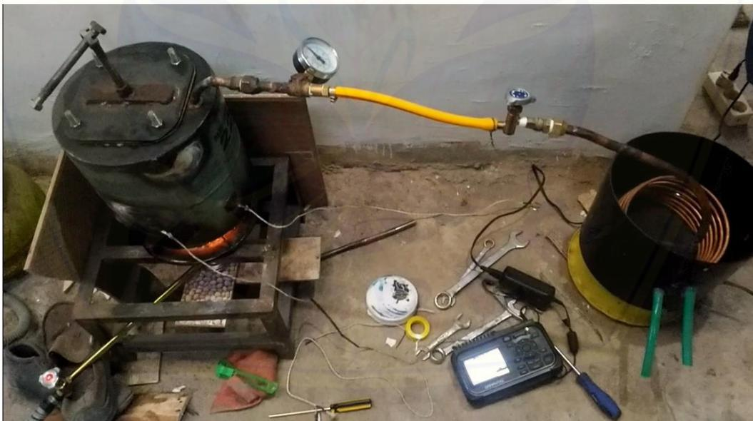
Gambar B.2 Rangkaian reaktor pirolisis bahan plastik
