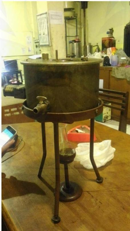
Gambar B.4 Pengujian viskositas minyak pirolisis
