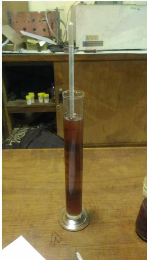
Gambar B.6 Pengujian massa jenis minyak pirolisis
