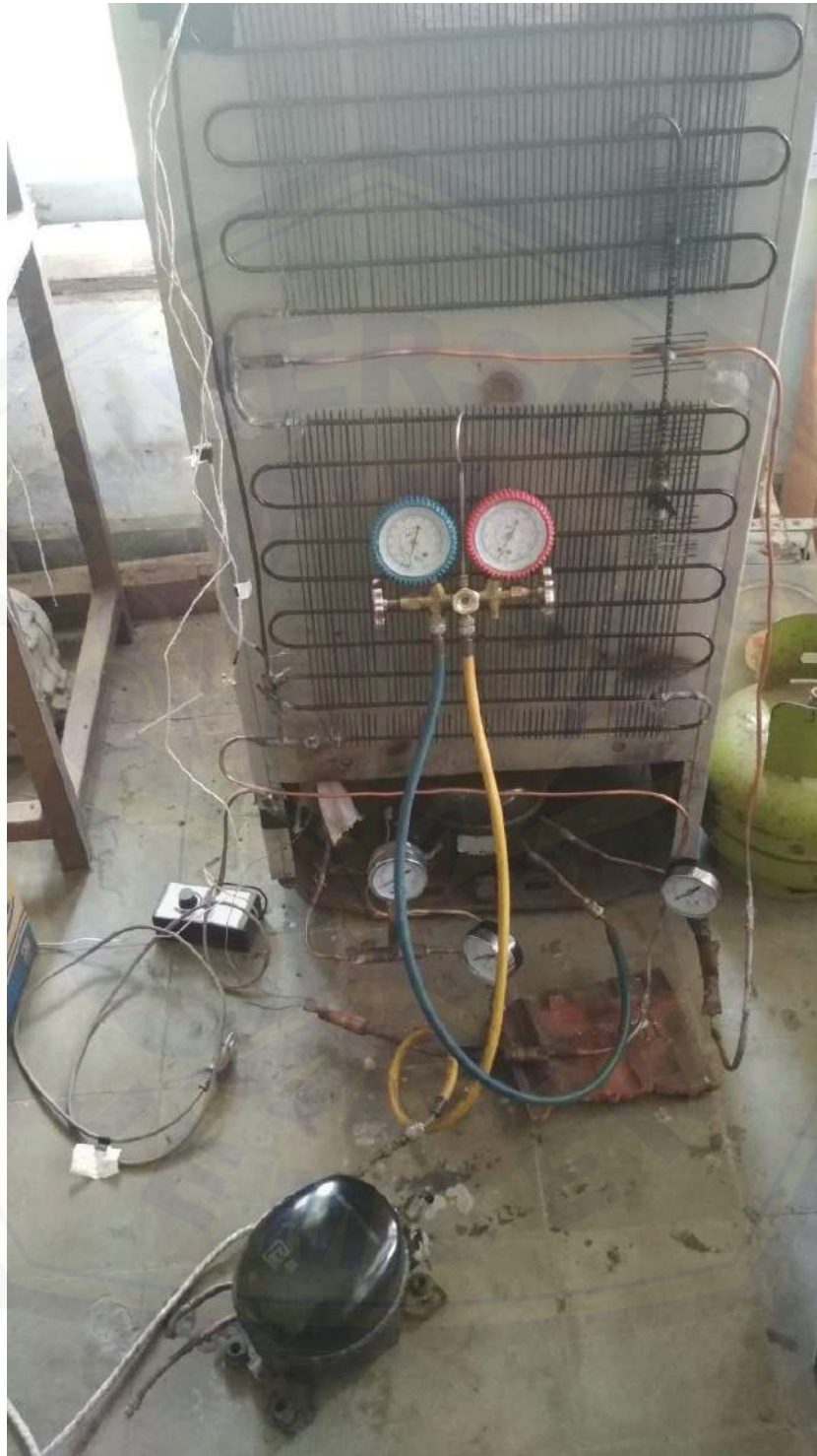
Gambar H.8 Proses Pemvakuman Mesin Pendingin Kulkas
