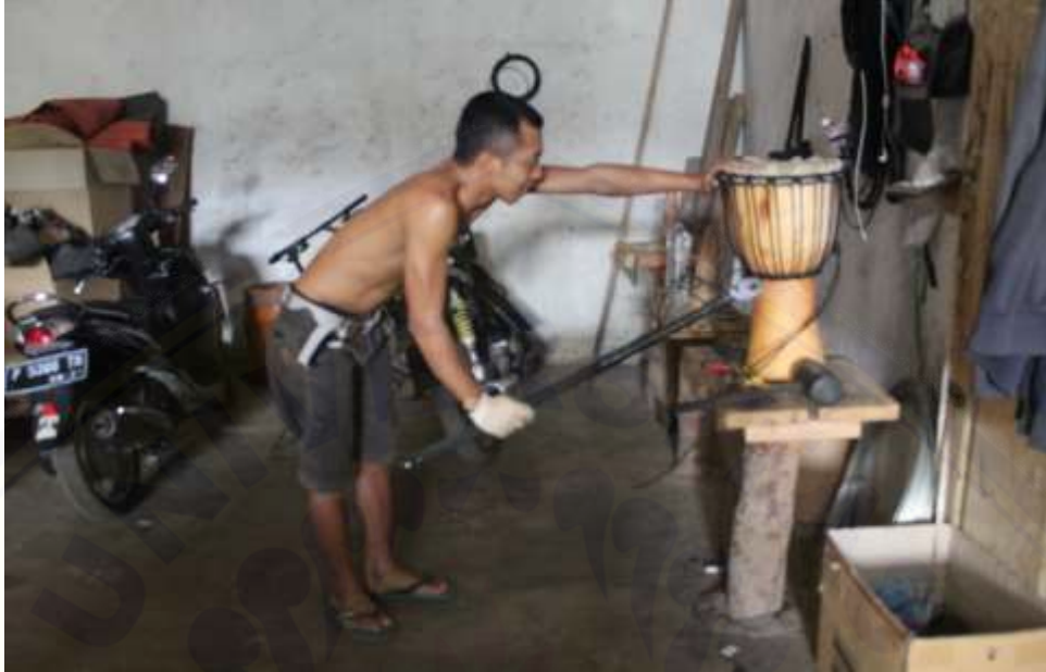
Gambar 11: Proses pemasangan kulit
