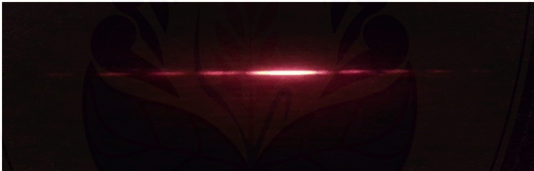
Gambar A.2 Pola difraksi Fraunhofer Aquades dengan menggunakan celah ganda
