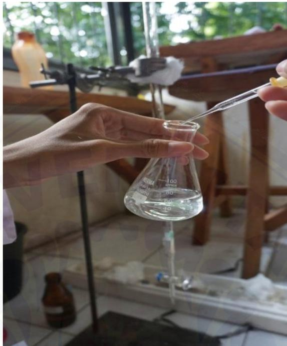
Gambar 7. Uji Oksigen Secara Titrasi
