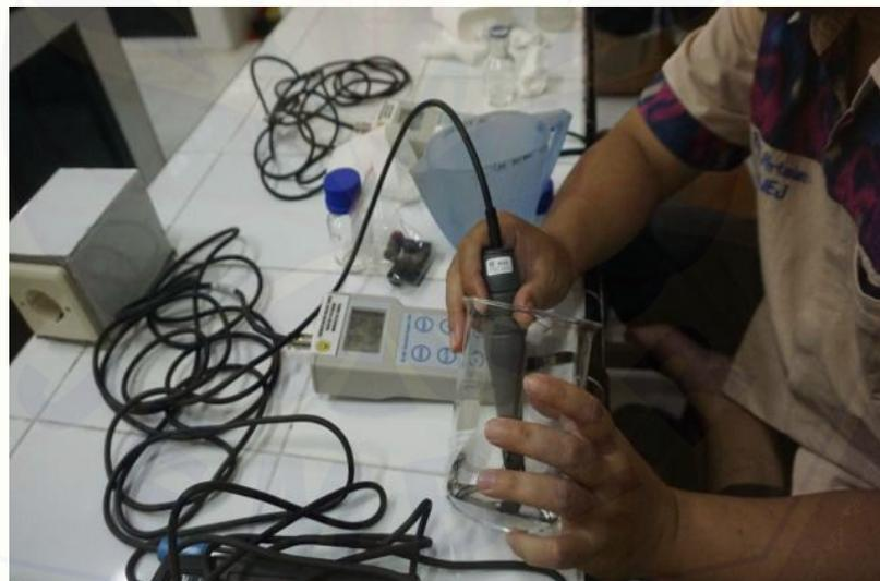
Gambar 6. Uji Oksigen Sampel Oleh Supervisi Menggunakan Oxugen meter
