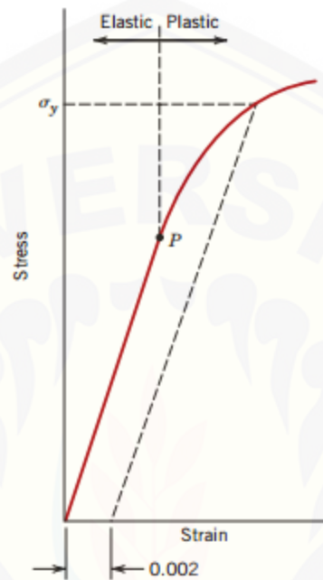
Gambar 2.4 Titik luluh dengan metode offset (Sumber: Callister, 2007)
