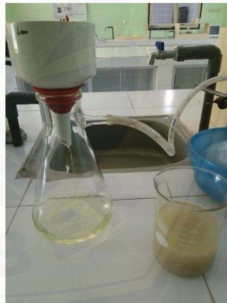
Gambar 8. Menyaring larutan selulosa dengan buchner
