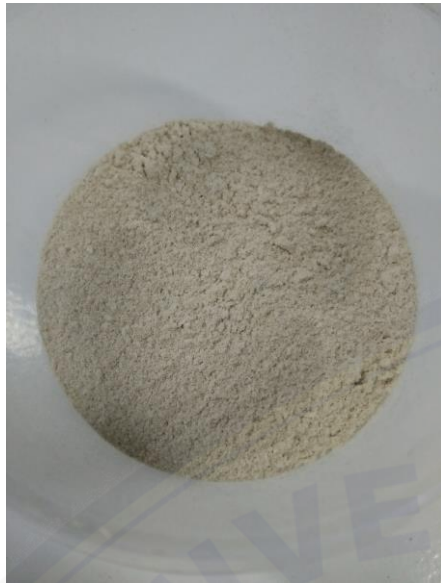
Gambar 9. Hasil pelarutan NaOH dengan serbuk batang semu pisang menjadi serbuk selulosa
