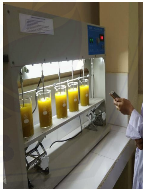
Gambar 12. Pengadukan menggunakan Jar Test pada sampel dengan variasi serbuk selulosa
