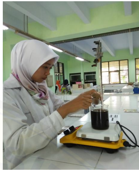
Gambar 6. Melarutkan serbuk batang semu pisang dengan NaOH
