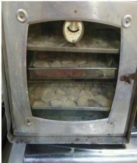
Gambar 3. Pengeringan batang semu pisang menggunakan oven
