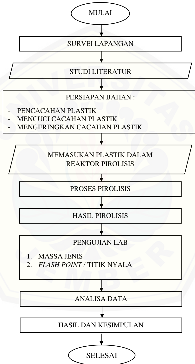
Gambar 3.5 Diagram Alir Pengolahan Sampah Plastik
