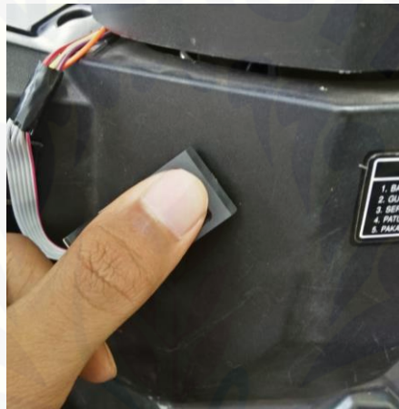
Gambar 4 Peletakan sidik jari untuk proses menghidupkan dan mematikan kelistrikan motor
