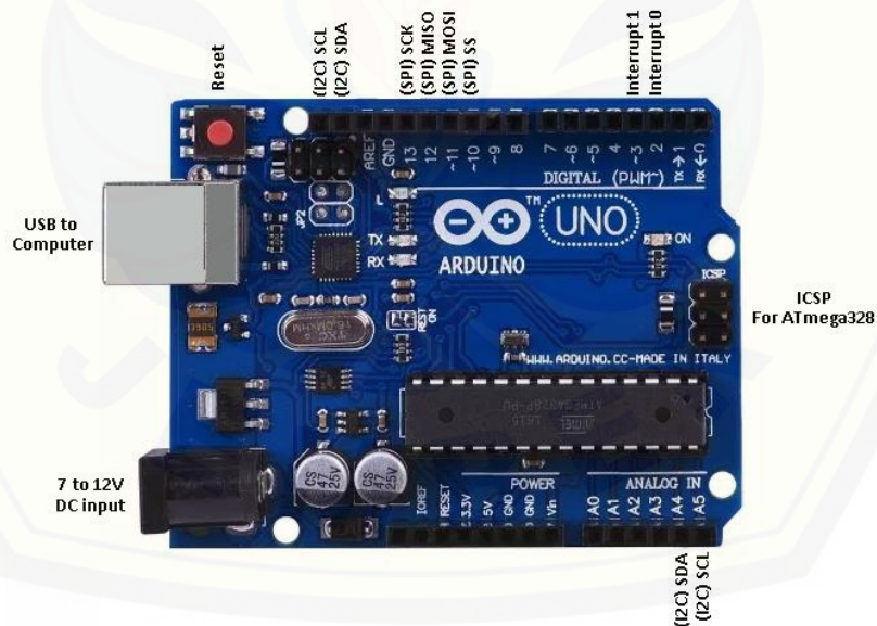
Gambar 2.1 Spesifikasi Arduino Uno
