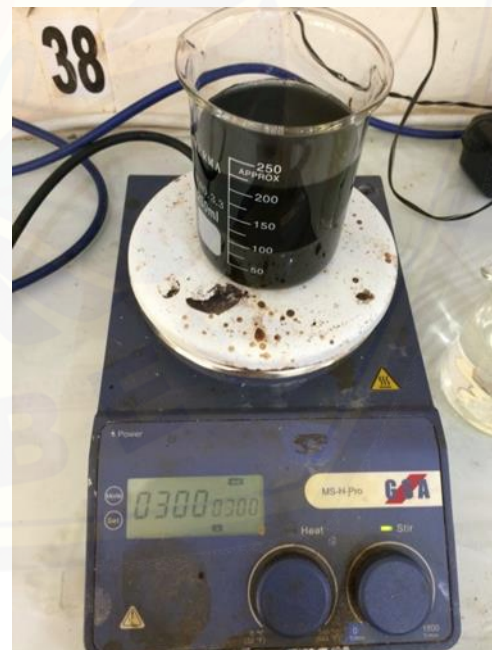
Gambar 16. Pengontakan arang dengan air sumur Pb
