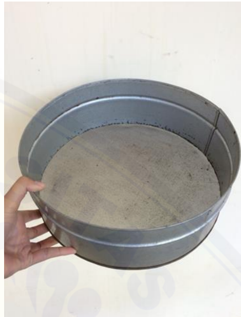
Gambar 10. Arang dihaluskan menggunakan 100 mesh
