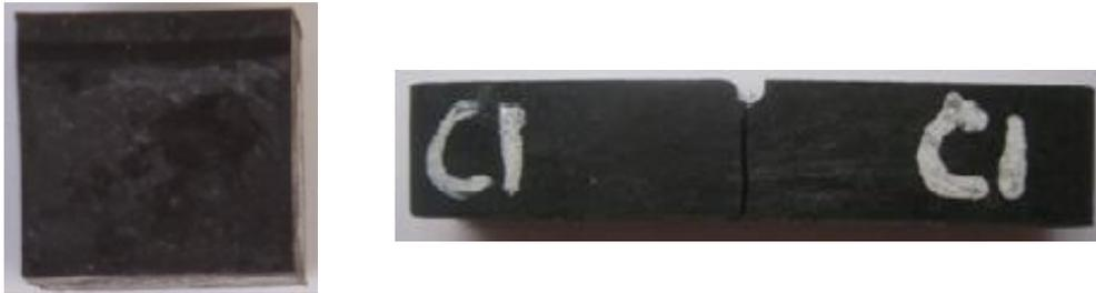
Gambar 4.8. Foto makro bentuk patahan uji impak pada pengerjaan 180<sup>0</sup>C – 40%
