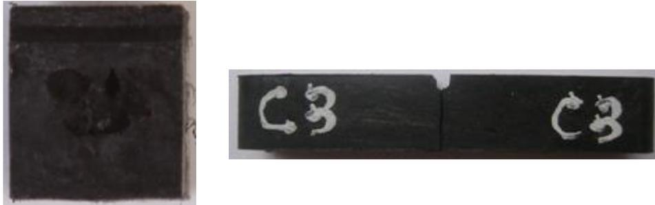
Gambar 4.14. Foto makro bentuk patahan uji impact pada pengerjaan 200°C – 40%
