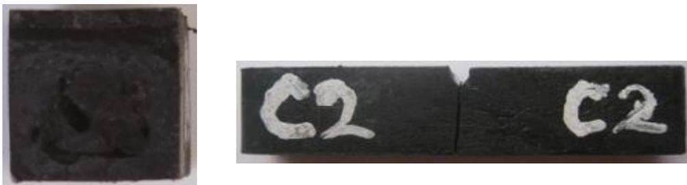
Gambar 4.11. Foto makro bentuk patahan uji impact pada pengerjaan 190<sup>0</sup>C – 40%
