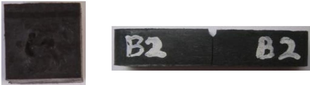
Gambar 4.10. Foto makro bentuk patahan uji impact pada pengerjaan 190<sup>0</sup>C – 30%
