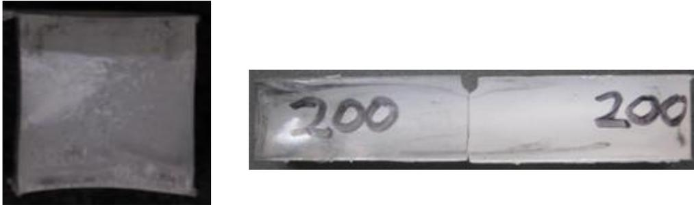
Gambar 4.17. Foto makro bentuk patahan uji impact pada PP murni dengan pengerjaan 200°C
