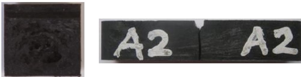
Gambar 4.9. Foto makro bentuk patahan uji impak pada pengerjaan 190<sup>0</sup>C – 20%
