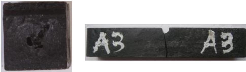
Gambar 4.12. Foto makro bentuk patahan uji impact pada pengerjaan 200<sup>0</sup>C – 20%
