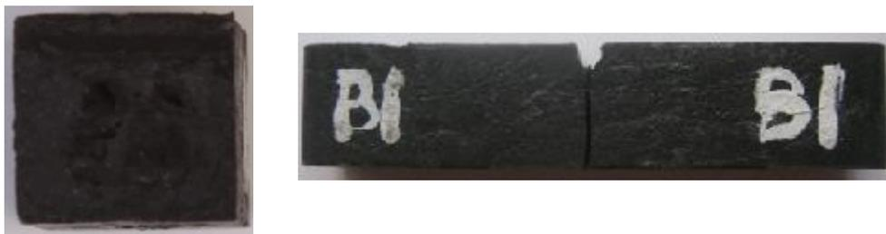
Gambar 4.7. Foto makro bentuk patahan uji impak pada pengerjaan  $180^{\circ}\text{C} - 30\%$
