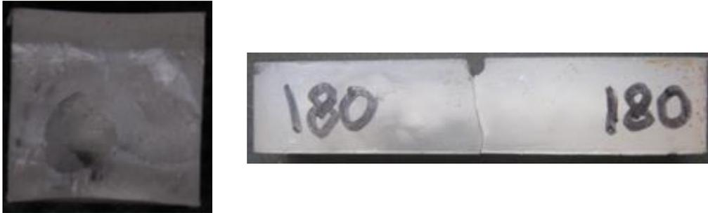
Gambar 4.15. Foto makro bentuk patahan uji impak pada PP murni dengan pengerjaan 180<sup>0</sup>C
