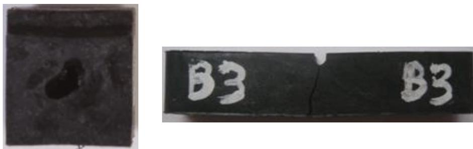
Gambar 4.13. Foto makro bentuk patahan uji impact pada pengerjaan 200<sup>0</sup>C – 30%
