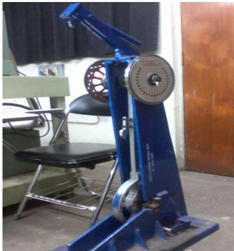
Gambar 3.2 Mesin Uji *Impact*
