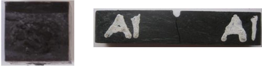
Gambar 4.6. Foto makro bentuk patahan uji impak pada pengerjaan  $180^{\circ}\text{C} - 20\%$
