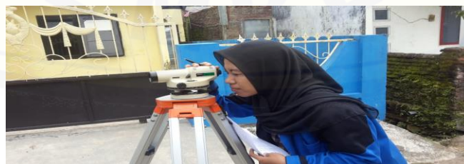
Gambar 6. Penembakan Waterpass Untuk Mengukur Elevsi
