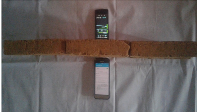
Pengukuran intensitas pada tembok (batu bata) ketebalan 4 cm
