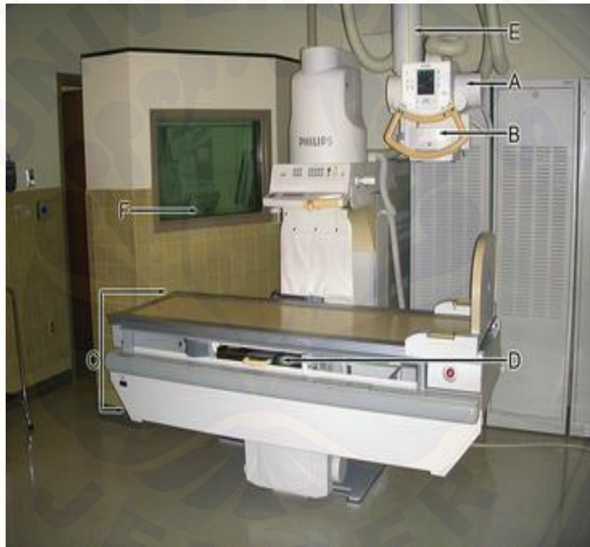
Gambar 2.3 Komponen utama general radiography a) tabung sinar-X, b) kolimator, c) meja radiografi, d) cassete tray , e) overhead tubecrane support dan f) generator console (Sumber : Adler dan Carlton, 2012)
