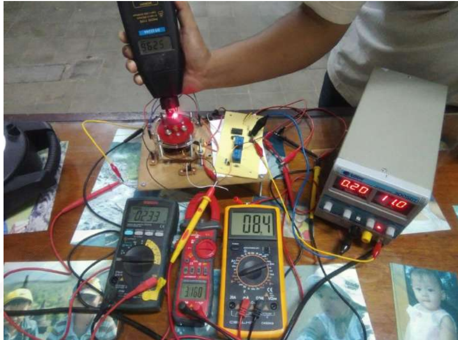
Gambar A.7 Pengujian pada lilitan 100 tegangan 11v
