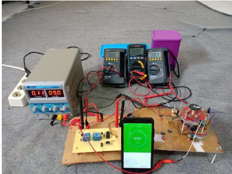
Gambar B.31 Pengujian ketahanan relay saat mati
