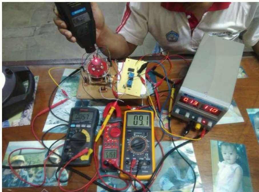
Gambar A.40 Pengujian pada lilitan 400 tegangan 11v
