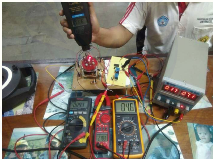
Gambar A.14 Pengujian pada lilitan 200 tegangan 7v
