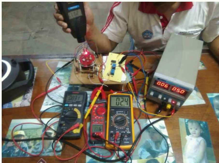
Gambar A.34 Pengujian pada lilitan 400 tegangan 5v
