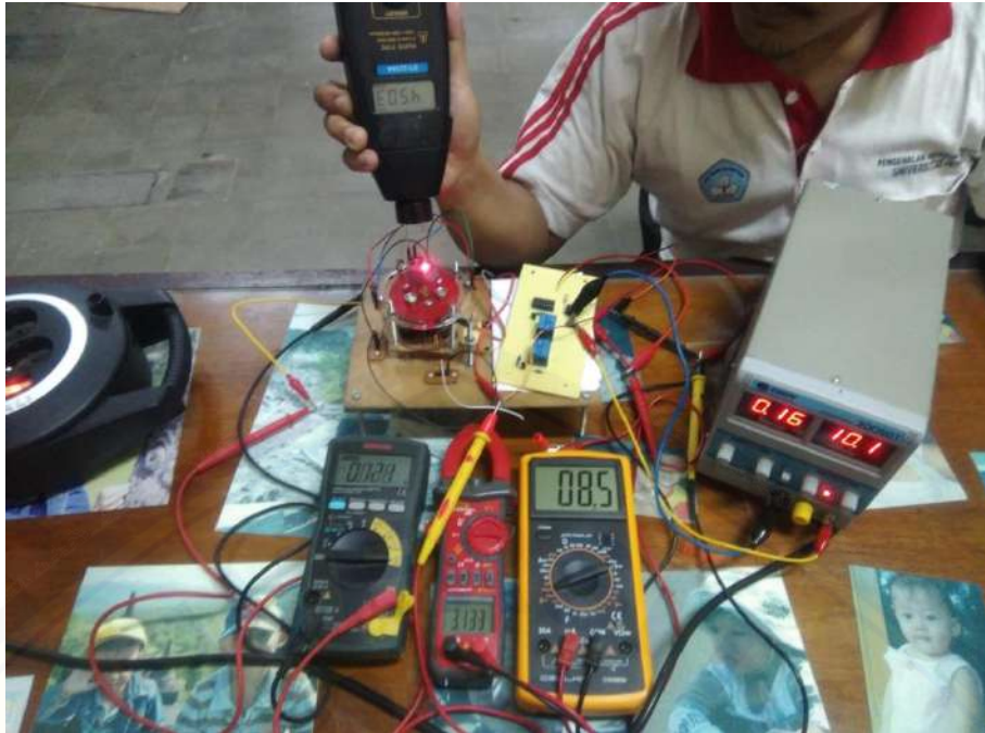
Gambar A.17 Pengujian pada lilitan 200 tegangan 10v
