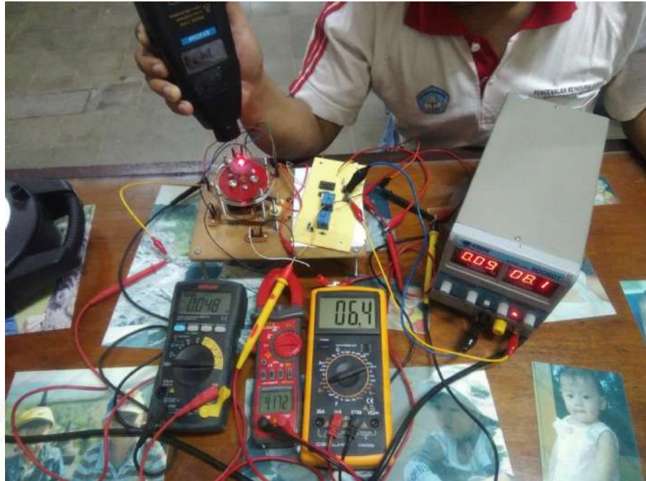
Gambar A.37 Pengujian pada lilitan 400 tegangan 8v
