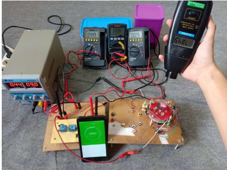
Gambar B.23 Pengujian ketahanan relay selama 23 menit
