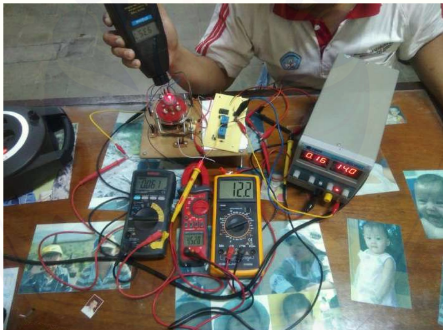
Gambar A.32 Pengujian pada lilitan 300 tegangan 14v
