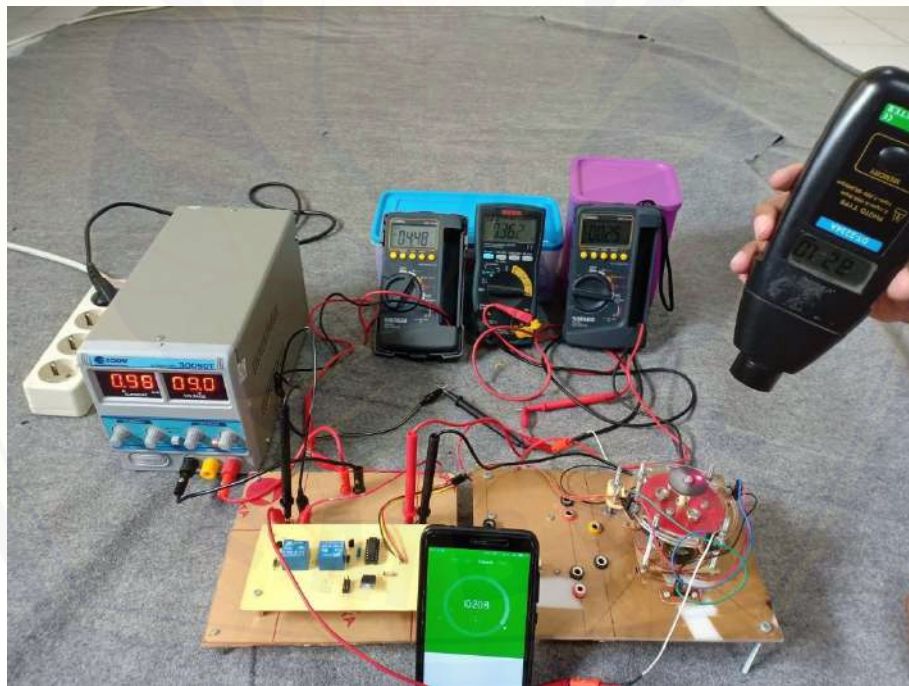
Gambar B.10 Pengujian ketahanan relay selama 10 menit
