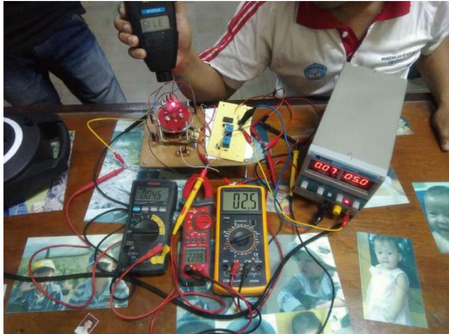
Gambar A.23 Pengujian pada lilitan 300 tegangan 5v
