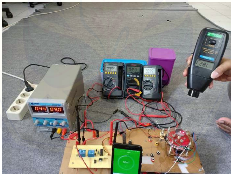
Gambar B.32 Pengujian ketahanan relay selama 1 menit
