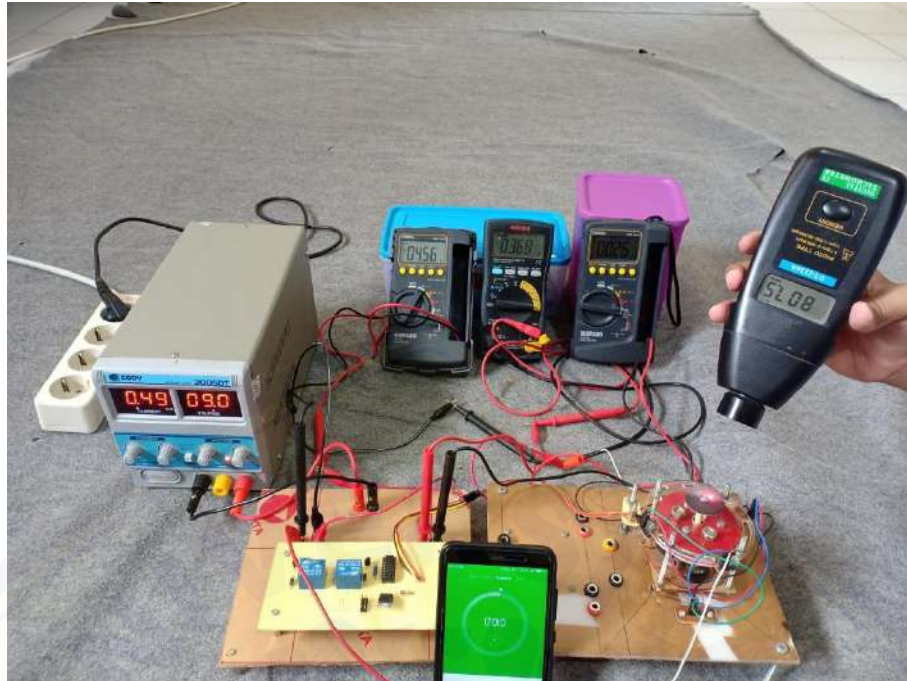
Gambar B.17 Pengujian ketahanan relay selama 17 menit
