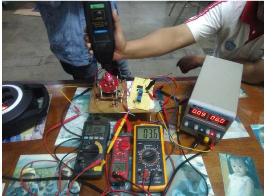
Gambar A.13 Pengujian pada lilitan 200 tegangan 6v
