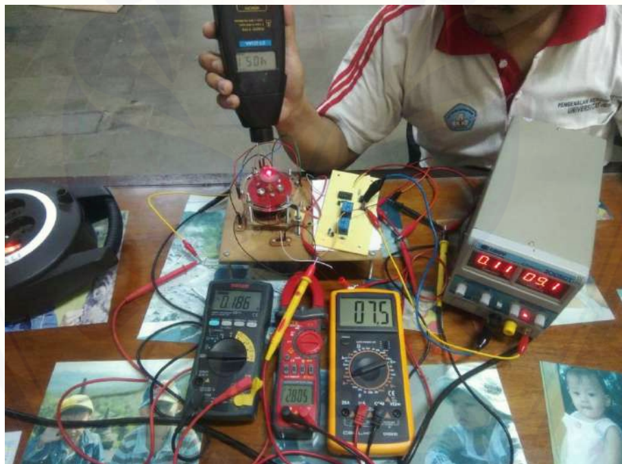
Gambar A.16 Pengujian pada lilitan 200 tegangan 9v
