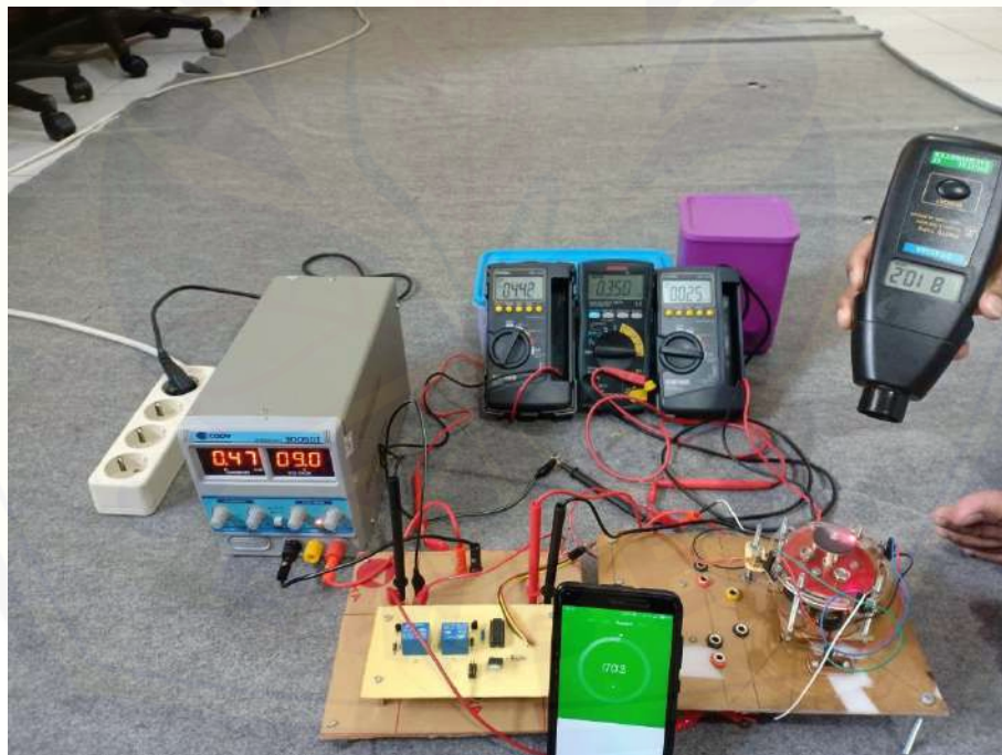
Gambar B.48 Pengujian ketahanan relay selama 17 menit
