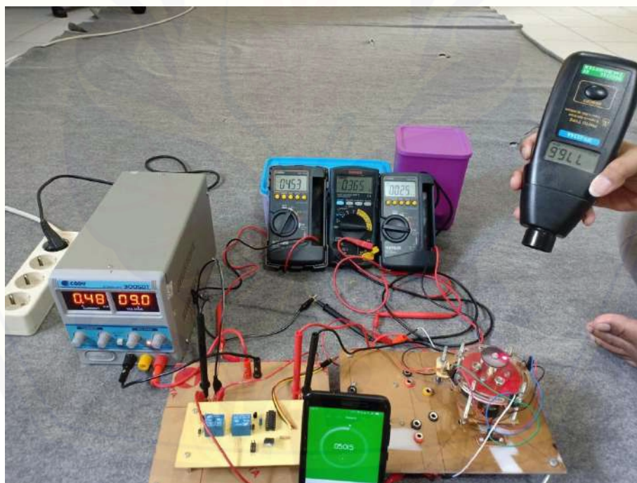
Gambar B.36 Pengujian ketahanan relay selama 5 menit
