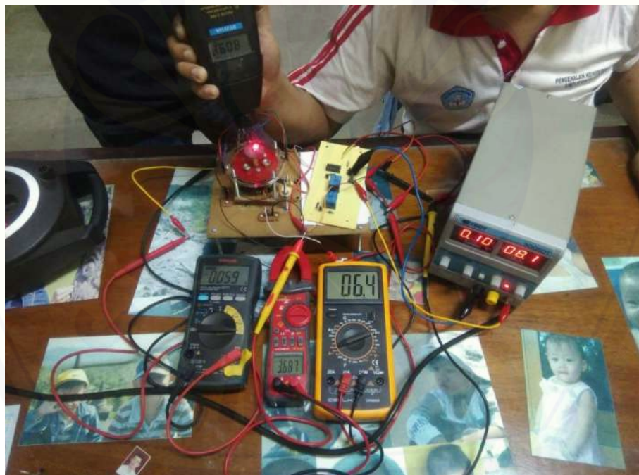
Gambar A.26 Pengujian pada lilitan 300 tegangan 8v
