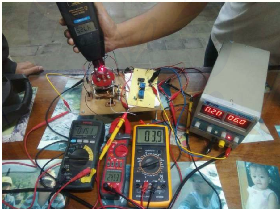
Gambar A.2 Pengujian pada lilitan 100 tegangan 6v
