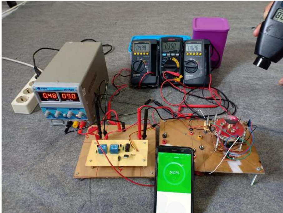
Gambar B.65 Pengujian ketahanan relay selama 34 menit
