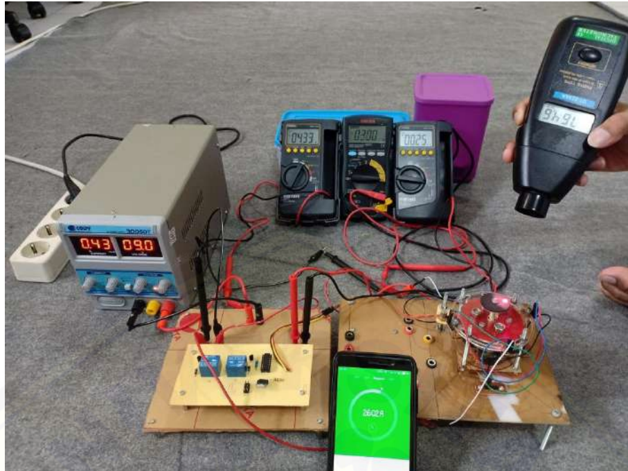
Gambar B.57 Pengujian ketahanan relay selama 26 menit
