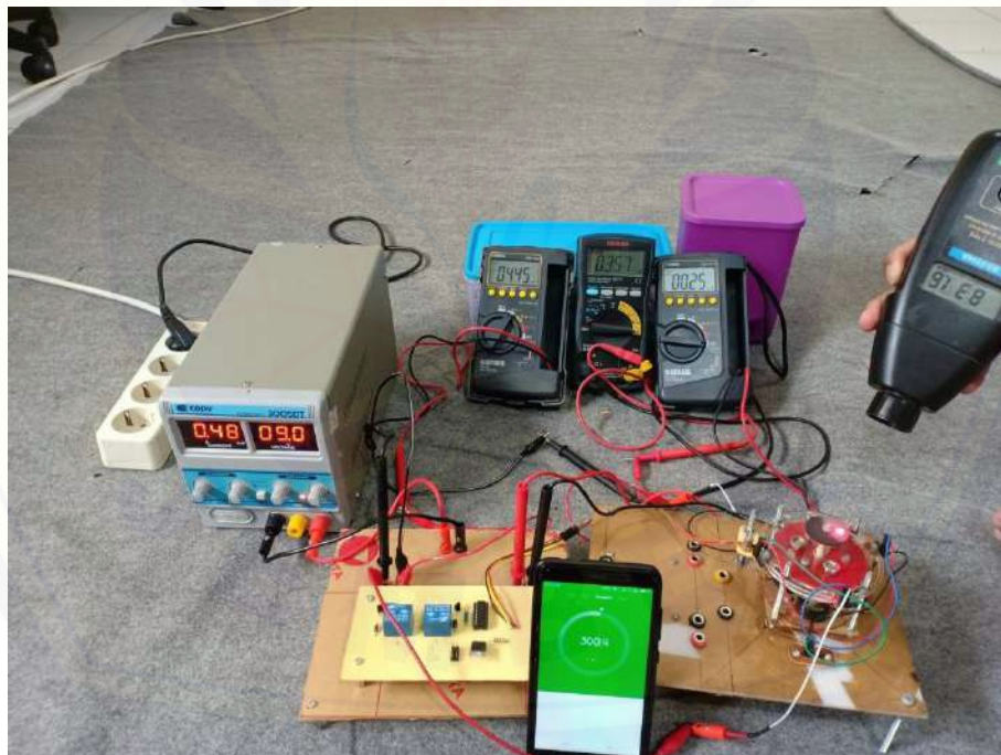
Gambar B.30 Pengujian ketahanan relay selama 30 menit
