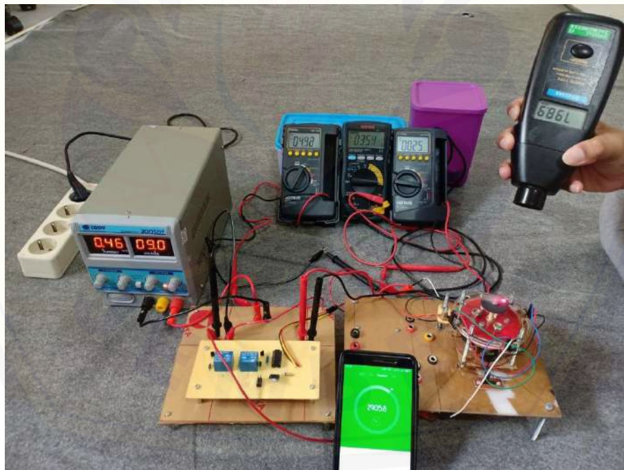
Gambar B.60 Pengujian ketahanan relay selama 29 menit
