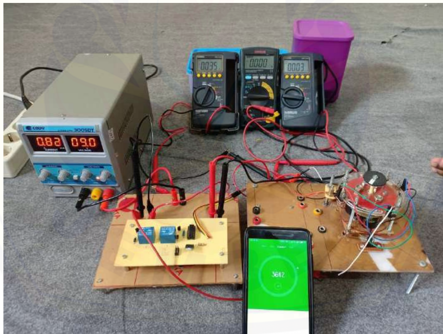
Gambar B.68 Pengujian ketahanan relay saat mati
