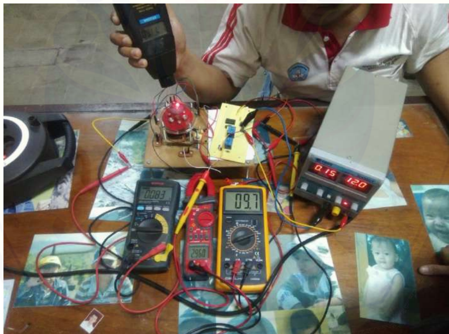
Gambar A.30 Pengujian pada lilitan 300 tegangan 12v
