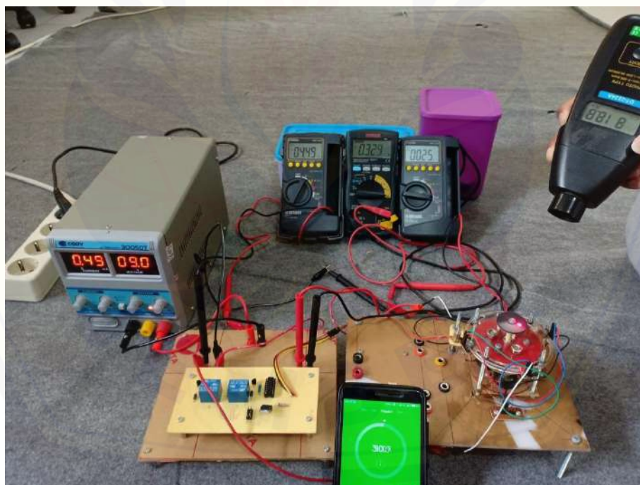
Gambar B.62 Pengujian ketahanan relay selama 31 menit
