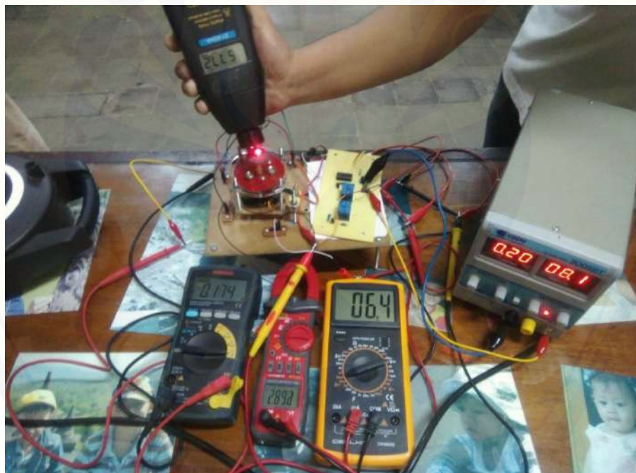
Gambar A.4 Pengujian pada lilitan 100 tegangan 8v
