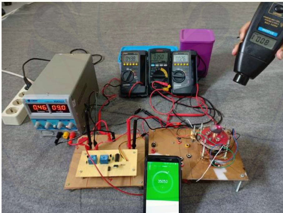
Gambar B.66 Pengujian ketahanan relay selama 35 menit
