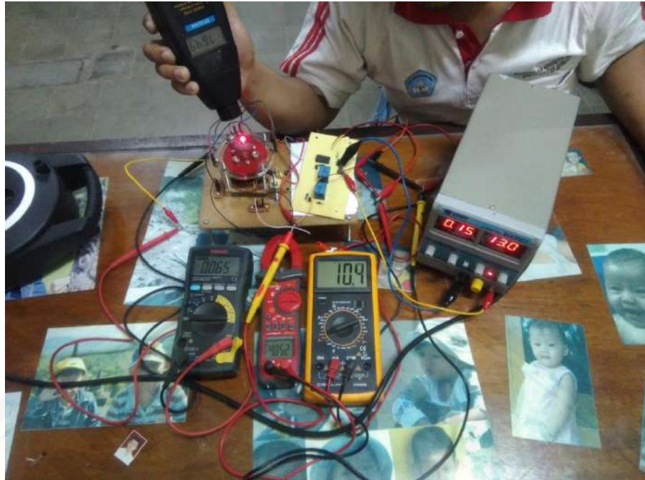
Gambar A.31 Pengujian pada lilitan 300 tegangan 13v
