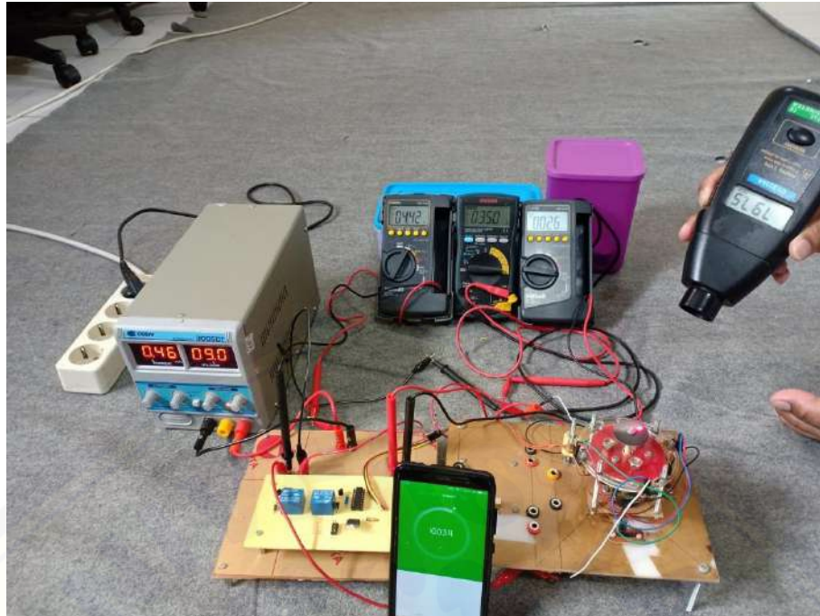
Gambar B.41 Pengujian ketahanan relay selama 10 menit
