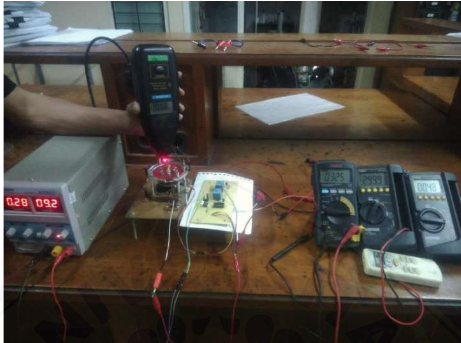
Gambar A.5 Pengujian pada lilitan 100 tegangan 9v
