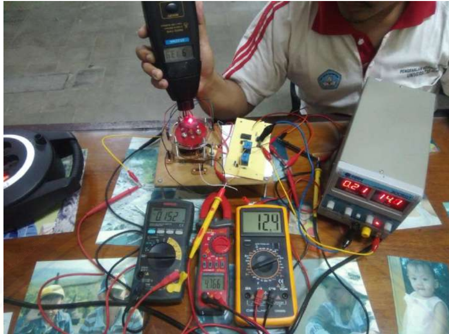
Gambar A.21 Pengujian pada lilitan 200 tegangan 14v
