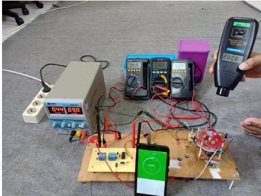
Gambar B.49 Pengujian ketahanan relay selama 18 menit
