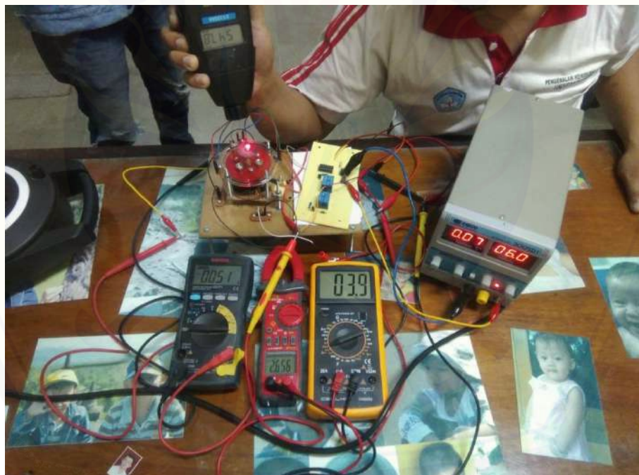
Gambar A.24 Pengujian pada lilitan 300 tegangan 6v
