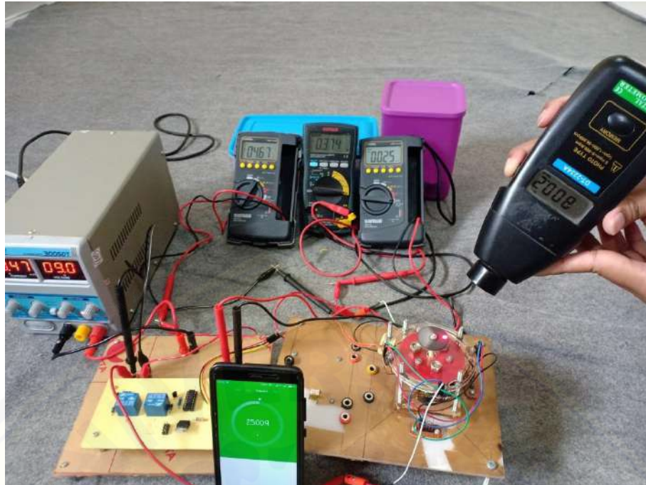
Gambar B.25 Pengujian ketahanan relay selama 25 menit
