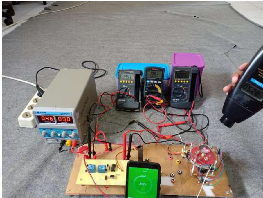
Gambar B.13 Pengujian ketahanan relay selama 13 menit
