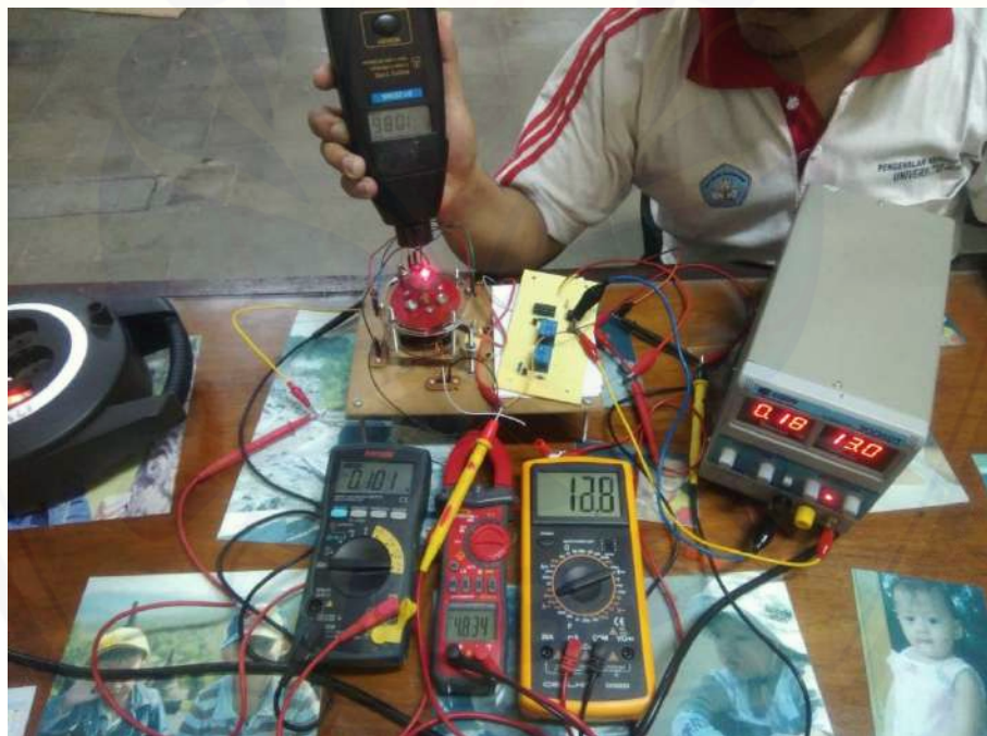
Gambar A.20 Pengujian pada lilitan 200 tegangan 13v
