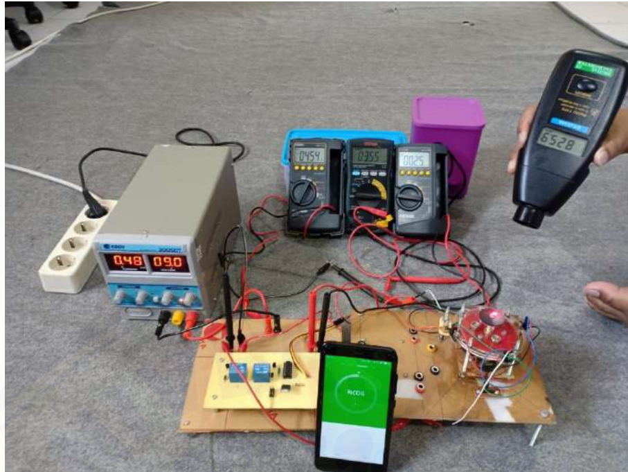
Gambar B.45 Pengujian ketahanan relay selama 14 menit
