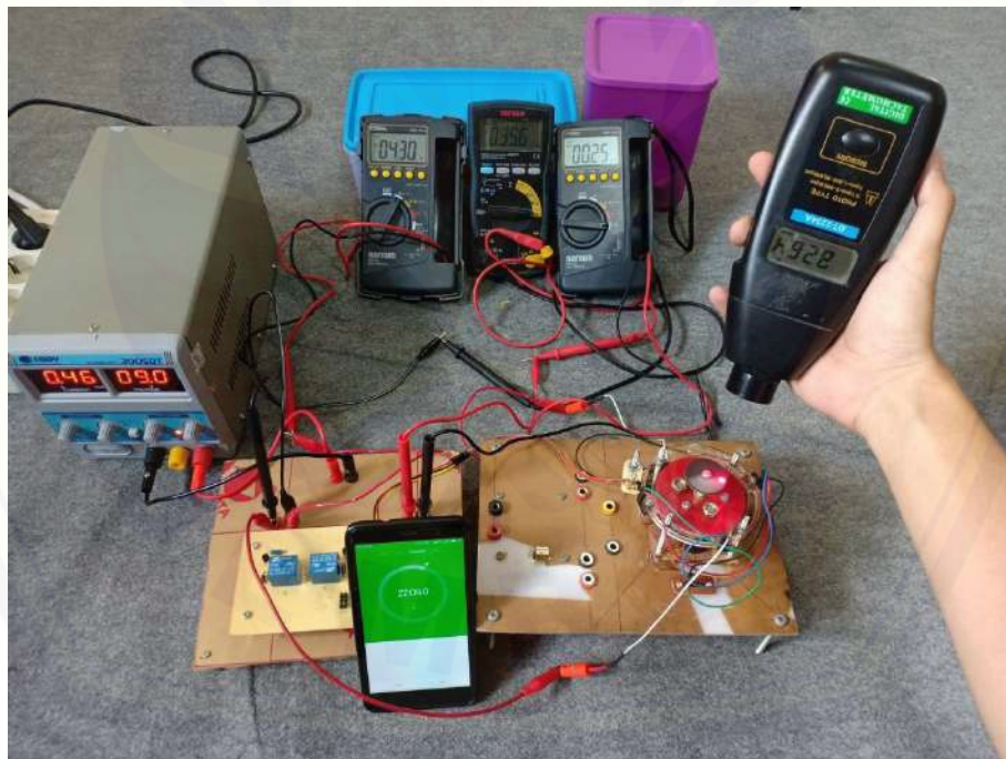
Gambar B.22 Pengujian ketahanan relay selama 22 menit
