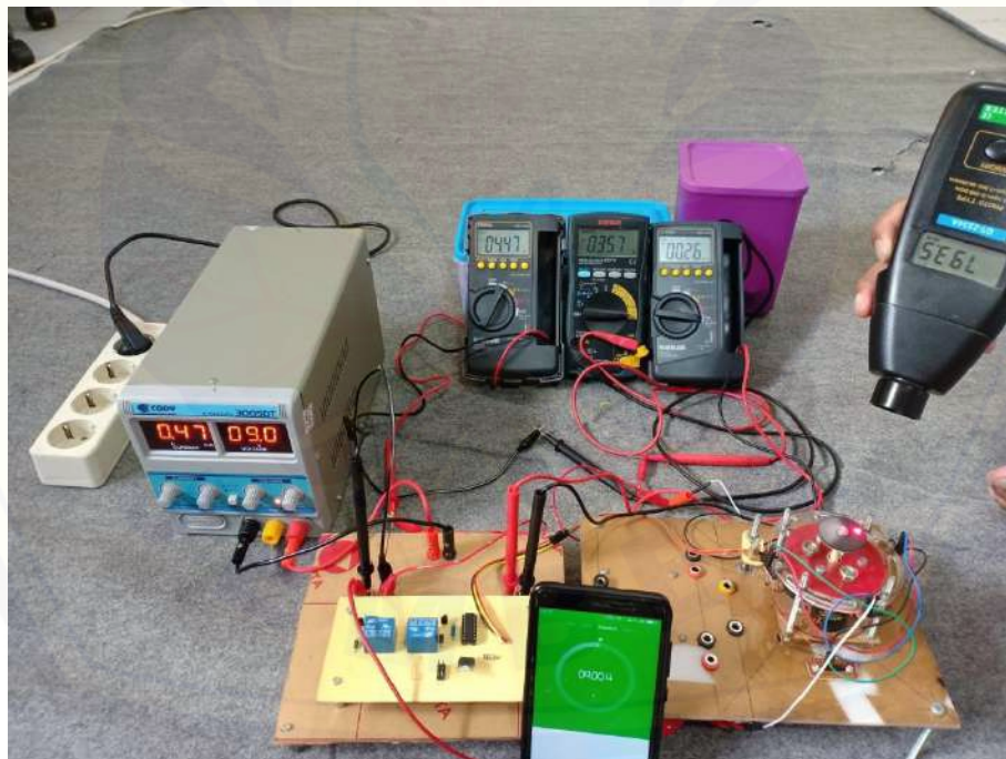
Gambar B.40 Pengujian ketahanan relay selama 9 menit
