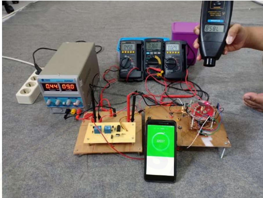
Gambar B.53 Pengujian ketahanan relay selama 22 menit
