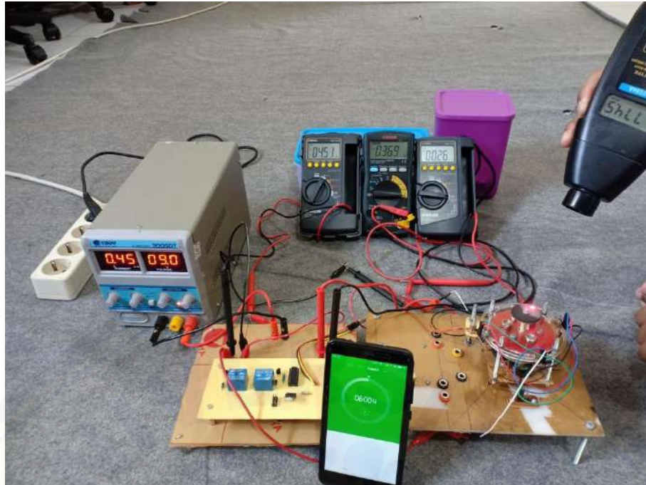
Gambar B.37 Pengujian ketahanan relay selama 6 menit
