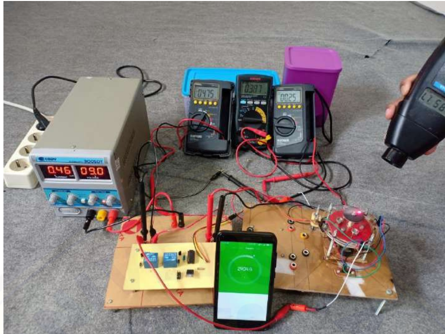
Gambar B.29 Pengujian ketahanan relay selama 29 menit
