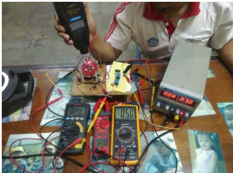
Gambar A.36 Pengujian pada lilitan 400 tegangan 7v
