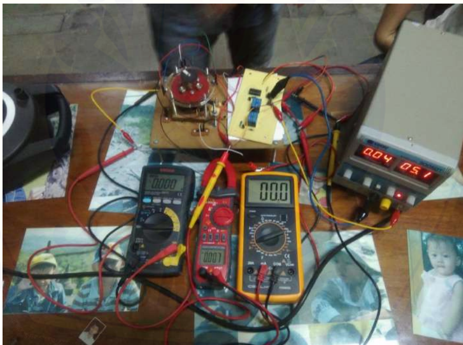
Gambar A.12 Pengujian pada lilitan 200 tegangan 5v
