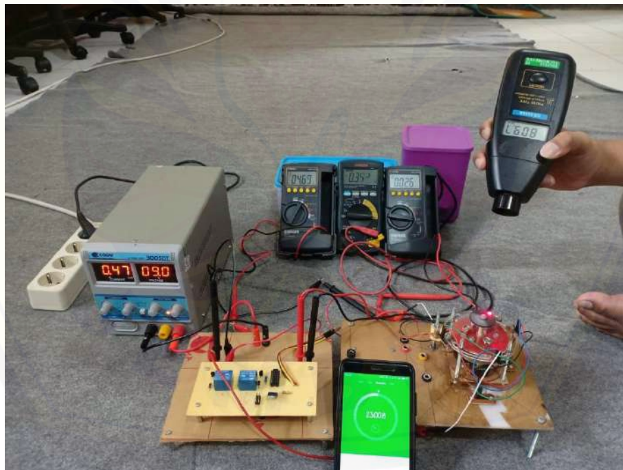
Gambar B.54 Pengujian ketahanan relay selama 23 menit
