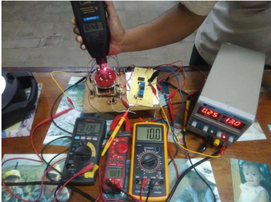
Gambar A.9 Pengujian pada lilitan 100 tegangan 13v
