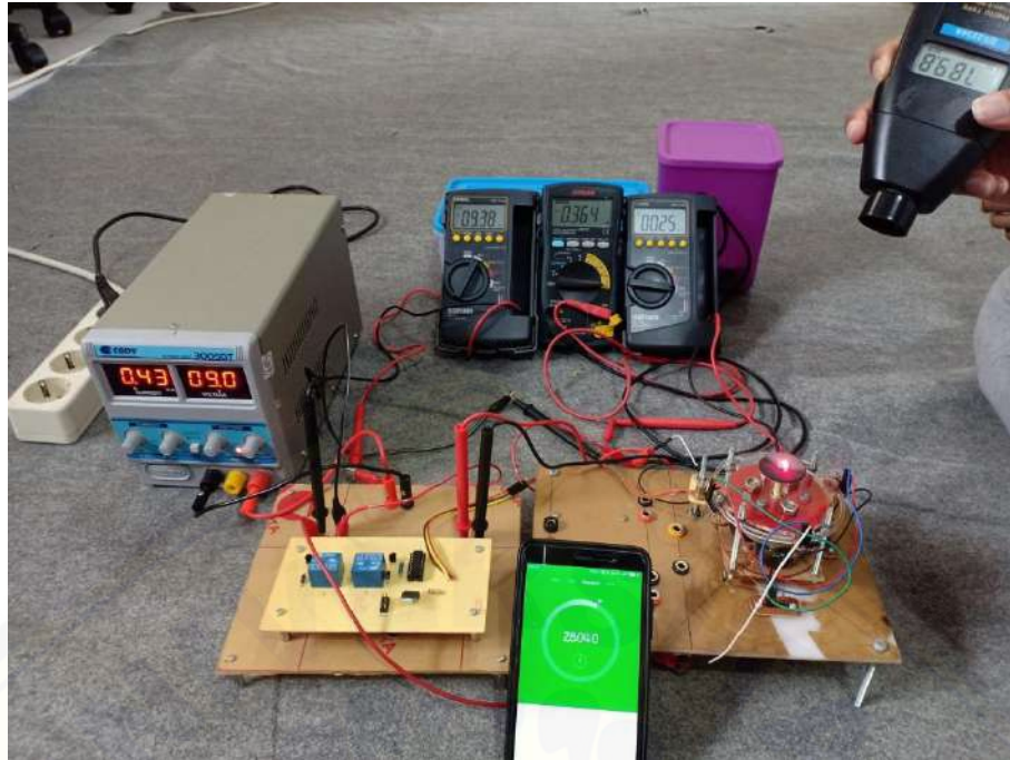
Gambar B.59 Pengujian ketahanan relay selama 28 menit
