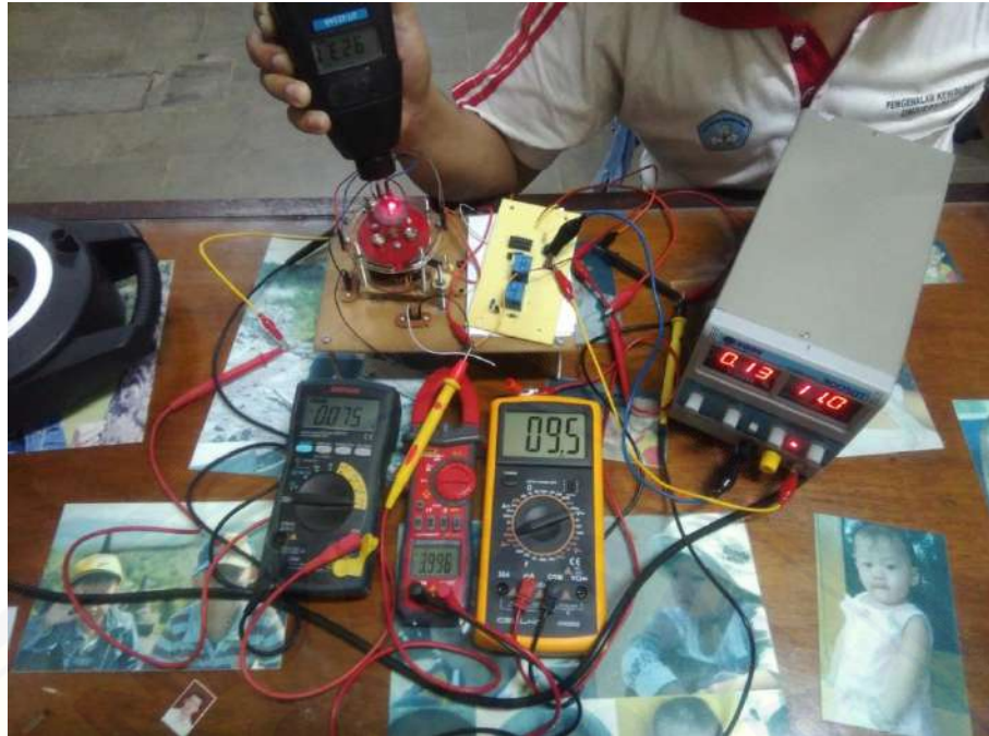
Gambar A.29 Pengujian pada lilitan 300 tegangan 11v
