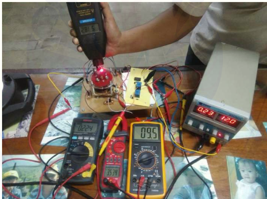
Gambar A.8 Pengujian pada lilitan 100 tegangan 12v
