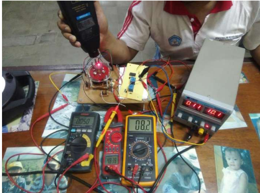
Gambar A.39 Pengujian pada lilitan 400 tegangan 10v
