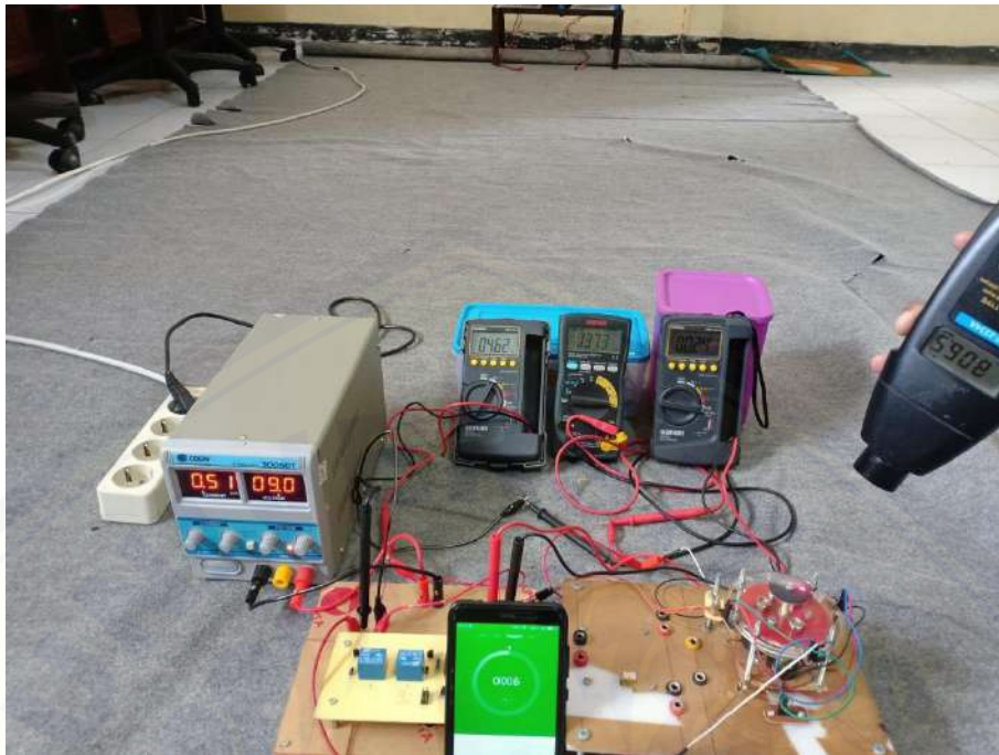
Gambar B.1 Pengujian ketahanan relay selama 1 menit
