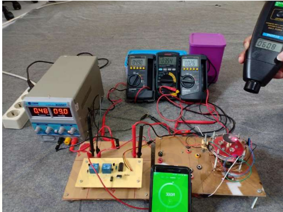
Gambar B.61 Pengujian ketahanan relay selama 30 menit
