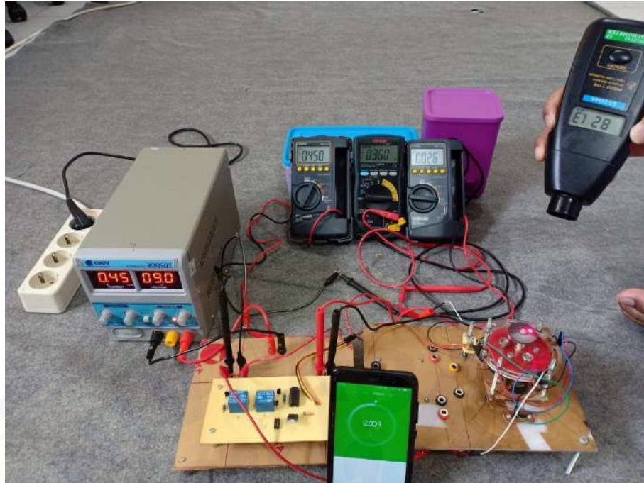
Gambar B.43 Pengujian ketahanan relay selama 12 menit
