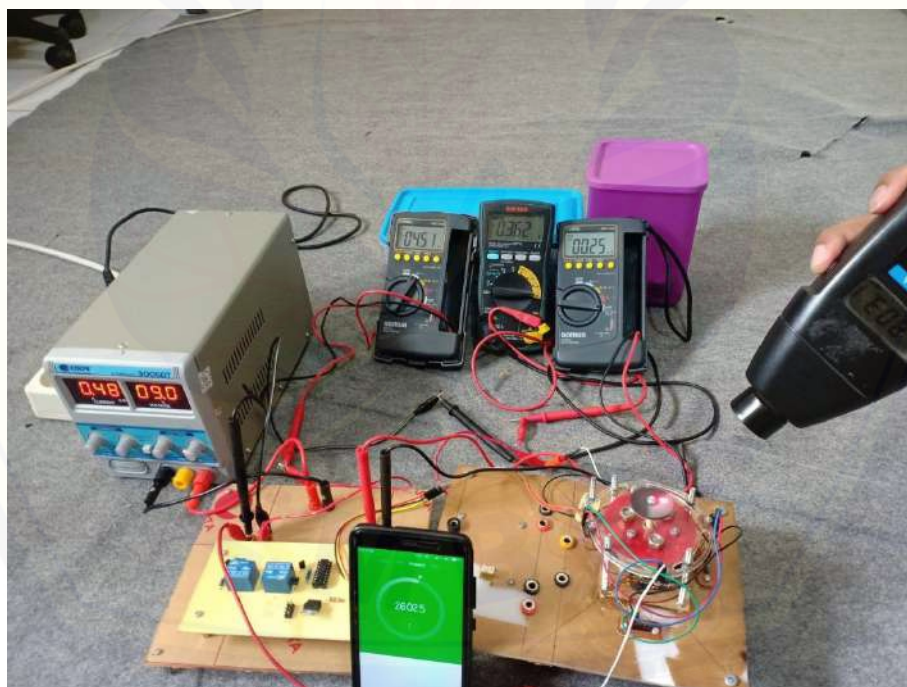
Gambar B.26 Pengujian ketahanan relay selama 26 menit
