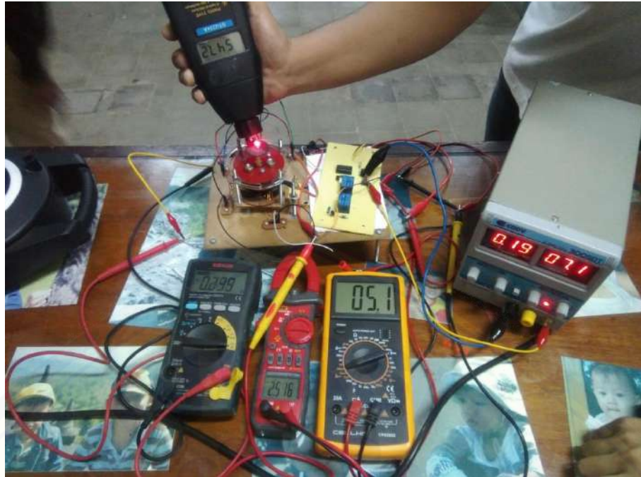
Gambar A.3 Pengujian pada lilitan 100 tegangan 7v
