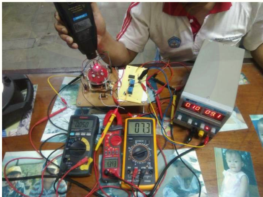
Gambar A.38 Pengujian pada lilitan 400 tegangan 9v
