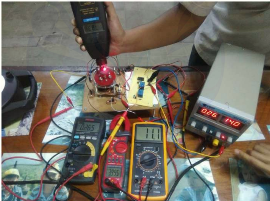
Gambar A.10 Pengujian pada lilitan 100 tegangan 14v
