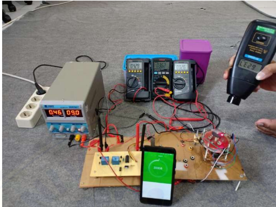
Gambar B.51 Pengujian ketahanan relay selama 20 menit
