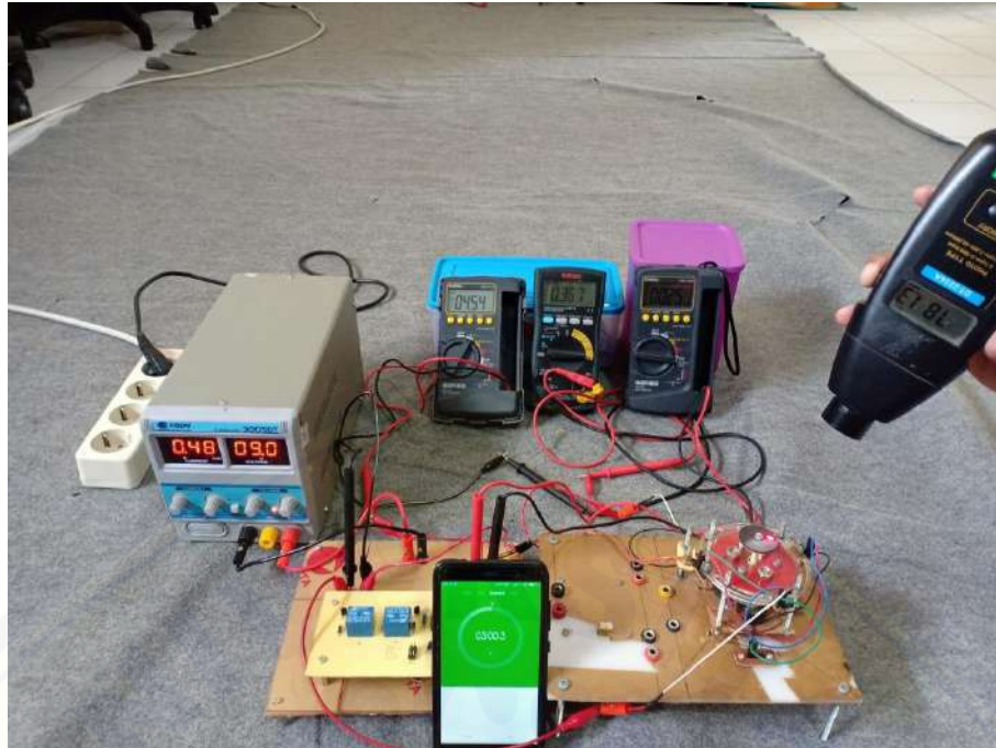
Gambar B.3 Pengujian ketahanan relay selama 3 menit
