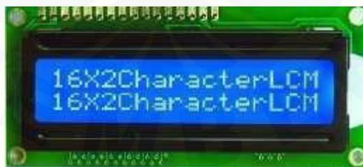
Gambar 2.7 Bentuk Fisik LCD 16x2
