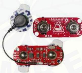
Gambar 3.19 MyoWare™ Muscle Sensor untuk akuisisi sinyal EMG
