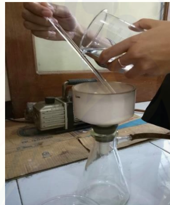
Penyaringan dengan corong Buchner
