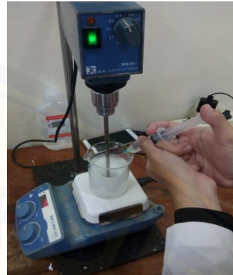
Pembentukan emulsi dengan kecepatan pengadukan 800 rpm
