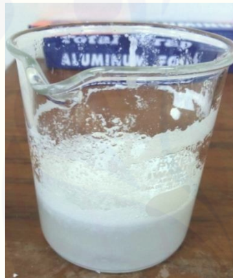
Terbentuk droplet hollow microspheres dalam fase aqueous
