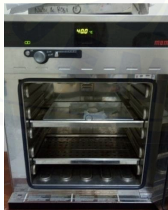
Pengeringan dengan oven pada suhu 40 o C
