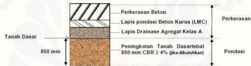
Struktur Perkerasan Kaku Pada Galian
