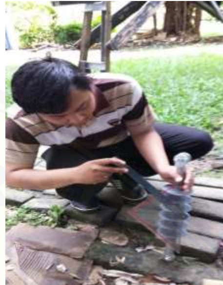
Pengukuran Jarak Sudut Penyemprotan
