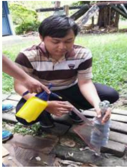
Gambar 3.1 Proses Penyemprotan Isolator Polimer Jenis Tarik
