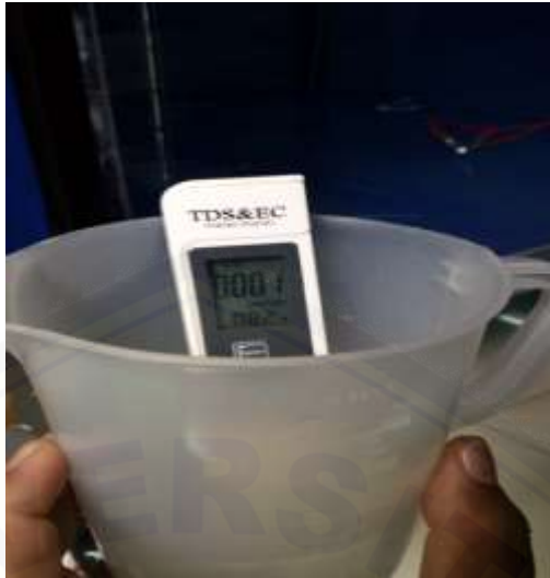
Gambar 3.3 Pengukuran Konduktivitas Menggunakan EC Meter
