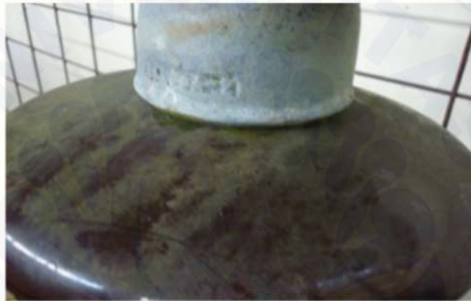
Gambar 2.4 Isolator berpolutan lumut
