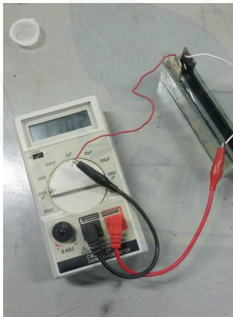
Gambar 4.8.2 Pengukuran kapasitansi bahan dengan kapasitansimeter
