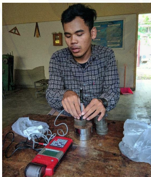
Gambar C.4.5 pelaksanaan uji kekerasan dengan micro hardness tester
