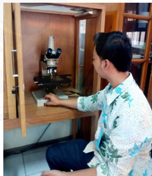
Gambar C.4.5 pelaksanaan uji struktur mikro menggunakan mikroskop optik
