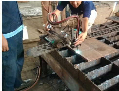
Gambar C.1.2 Pemotongan plat dari lembaran besar
