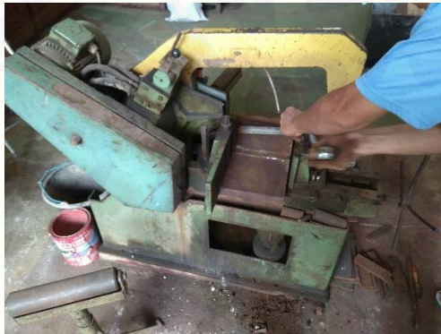
Gambar C.2.1 Pemotongan dengan mesin gerai
