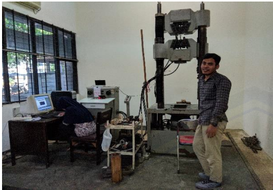
Gambar C.4.1 Alat Uji Tarik dan komputer pengambil data
