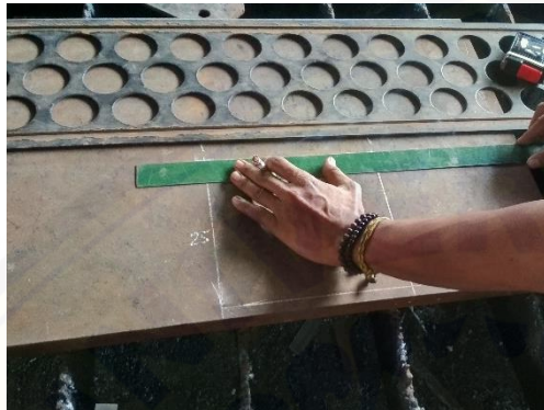
Gambar C.1.1 Pengukuran plat untuk pengelasan
