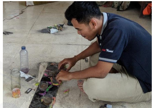
Gambar C.4.2 Mencetak spesimen mounting
