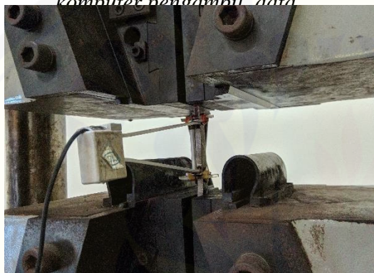
Gambar C.4.3 Proses pengujian dengan ekstensometer
