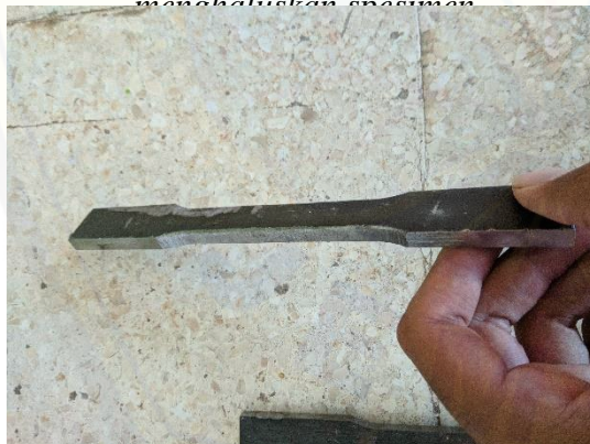
Gambar C.4.5 spesimen uji tarik setelah di sekrap
