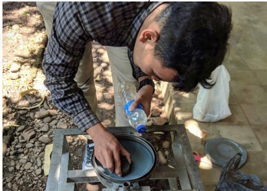
Gambar C.4.3 proses Grinding menghaluskan spesimen
