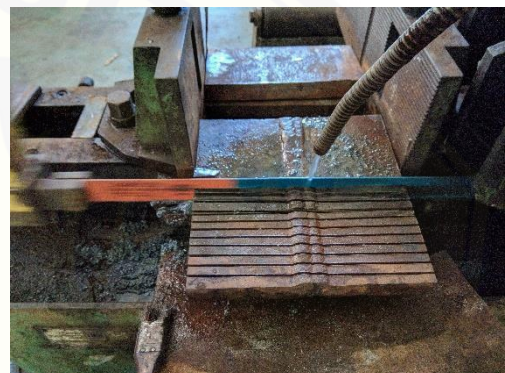
Gambar C.2.2 cooling water pada pemotongan
