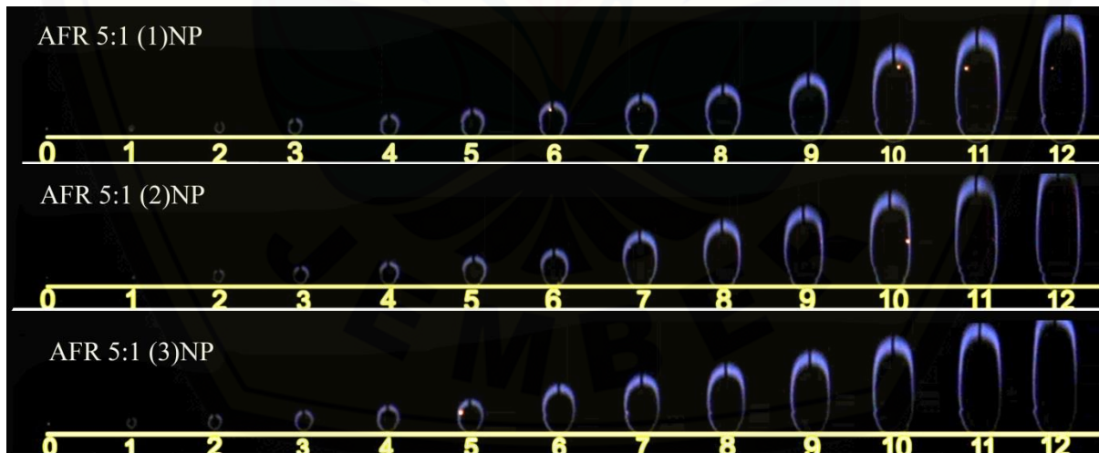
Lampiran C.2 Nyala api pada biogas tanpa purifikasi dengan AFR 5:1
