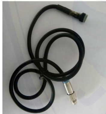
A.3 Kabel konektor Em-Stat PalmSense® dengan elektroda
