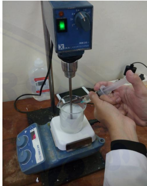
Pembentukan droplet hollow microspheres dengan pengadukan
