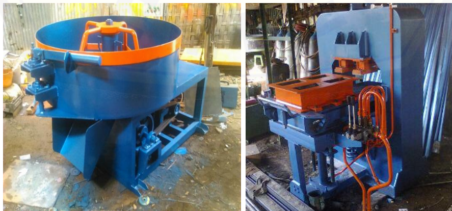
Gambar 3.2 Alat Mixer dan Mesin Press Paving Block
