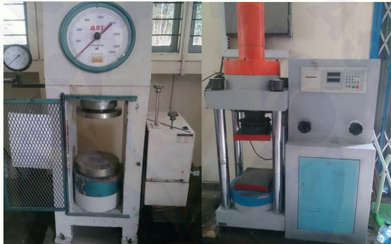
Gambar 3.3 Alat Uji Kuat Tekan Manual dan Digital
