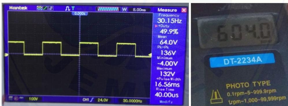
Gambar 6. Pengujian Motor Tegangan 13 V Dengan Frekuensi 30 Hz Menggunakan Osiloskop dan Tachometer
