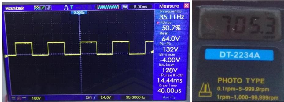
Gambar 7. Pengujian Motor Tegangan 13 V Dengan Frekuensi 35 Hz Menggunakan Osiloskop dan Tachometer
