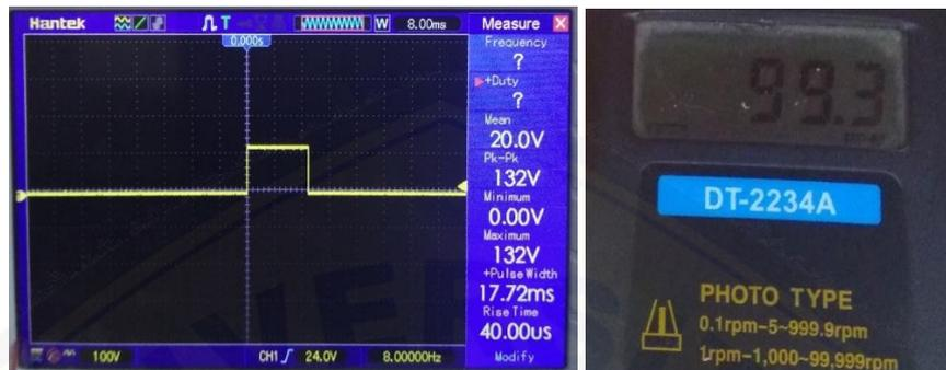
Gambar 1. Pengujian Motor Tegangan 13 V Dengan Frekuensi 5 Hz Menggunakan Osiloskop dan Tachometer
