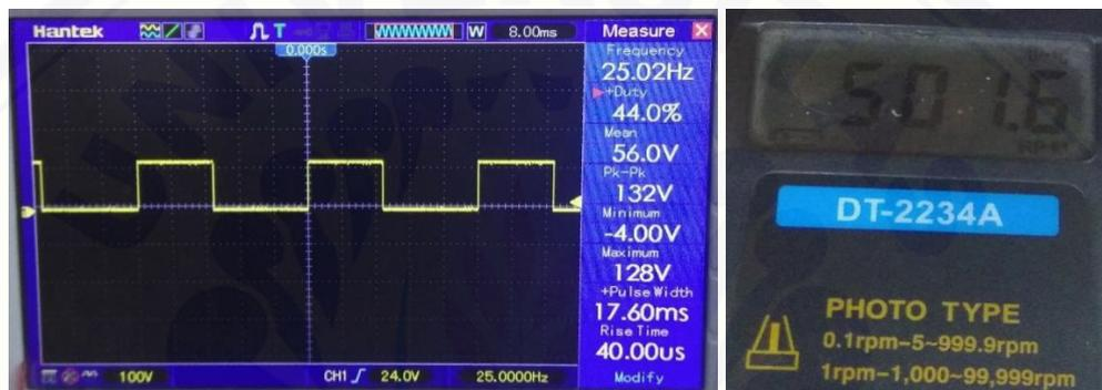
Gambar 5. Pengujian Motor Tegangan 13 V Dengan Frekuensi 25 Hz Menggunakan Osiloskop dan Tachometer
