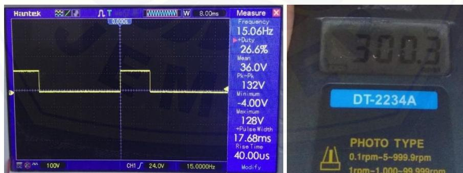
Gambar 3. Pengujian Motor Tegangan 13 V Dengan Frekuensi 15 Hz Menggunakan Osiloskop dan Tachometer
