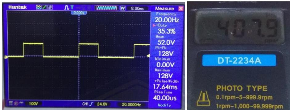
Gambar 4. Pengujian Motor Tegangan 13 V Dengan Frekuensi 20 Hz Menggunakan Osiloskop dan Tachometer
