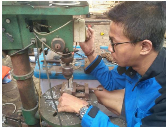
Gambar C.7 Proses pengeboran untuk naf pulley
