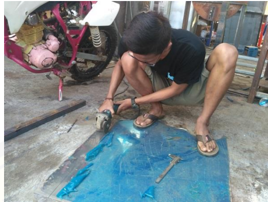
Gambar C.9 Proses penggerindaan plat untuk penampang adonan kerupuk
