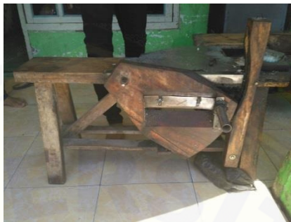
Gambar 2.2 Mesin perajang kerupuk
