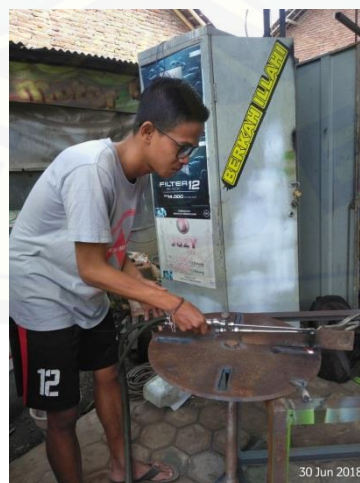
Gambar C.2 Proses pelubangan untuk tempat pisau
