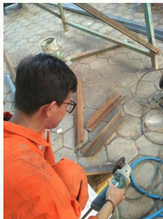
Gambar C.4 Proses penggerindaan besi L sebagai rangka
