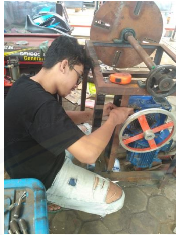
Gambar C.6 Proses pemasangan motor dan reducer
