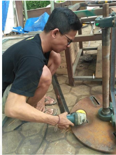
Gambar C.3 Proses penghalusan sisi samping tempat pisau
