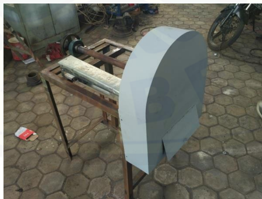
Gambar C.41 Desain Akhir Mesin Pemotong Adonan Kerupuk
