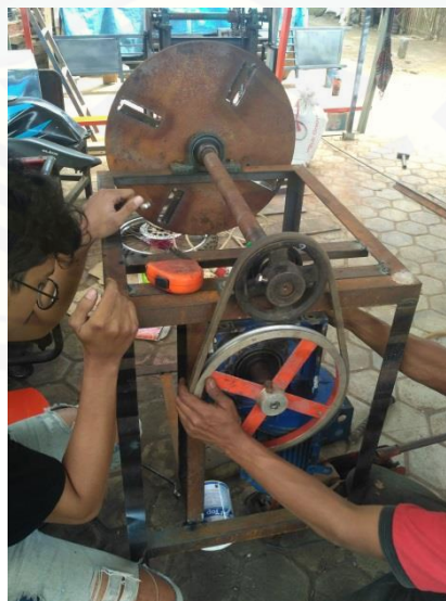
Gambar C.8 Proses pemasangan pulley
