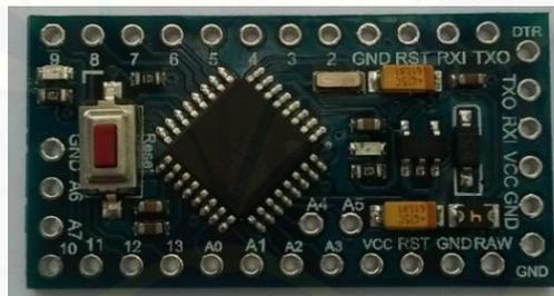
Gambar 2.3 Bagian Depan Arduino Pro Mini
