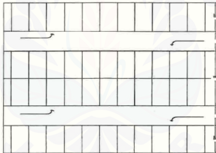
Gambar 2.11 Taman parkir tegak lurus dengan 2 gang (Sumber: Direktorat Jenderal Perhubungan Darat, 1998)
