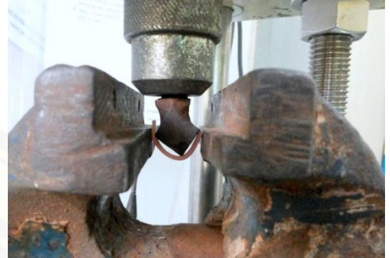
dilakukan uji tekan pada sampel sampai batas maksimal
