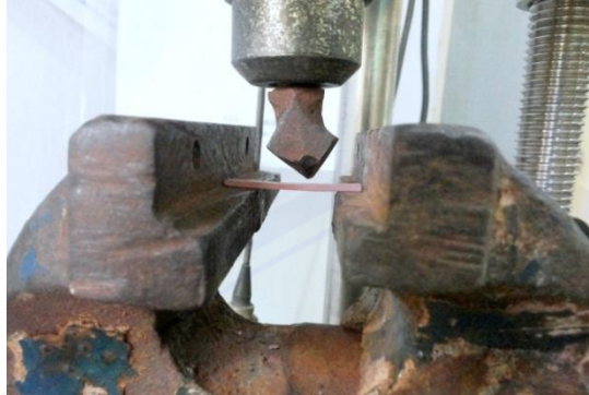
Alat uji Universal testing machine diletakkan pada tengah sampel
