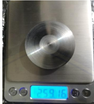
Gambar proses pengukuran berat awal benda kerja
