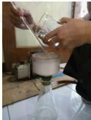
Penyaringan hollow microspheres
